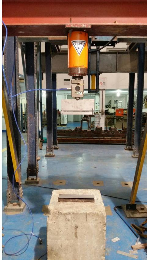
Figura 5.18: Esquema de ensaio com atuador FAREX 60 t.
