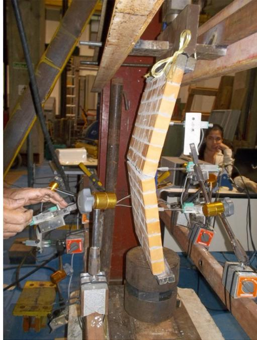
Figura 5.21: Parede com  $\lambda = 14$  ensaiada à flexo-compressão para  $e_1 = 0,5$ .
