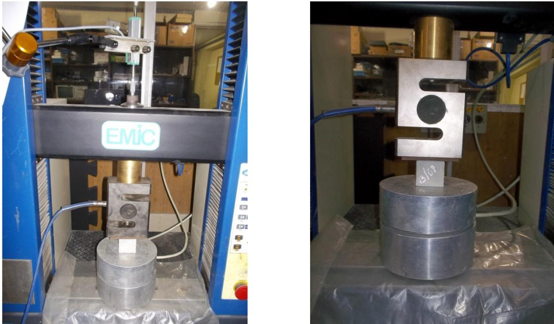
Figura 5.7: Ensaio à compressão da argamassa.
