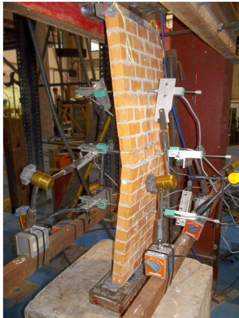
Figura 5.22: Parede com  $\lambda = 20$  ensaiada à flexo-compressão para  $e_1 = 1,0$ .
