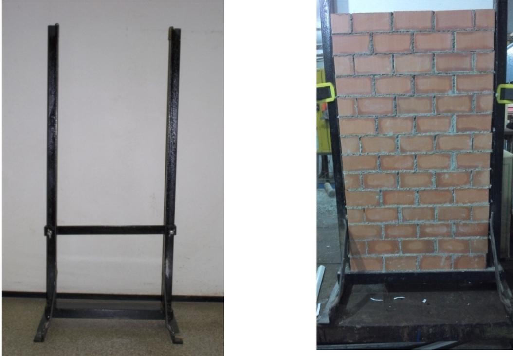
Figura 5.12: Aparato utilizado para auxiliar a construção das paredes.
