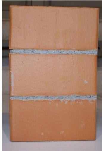
Figura 5.8: Prisma de três fiadas.
