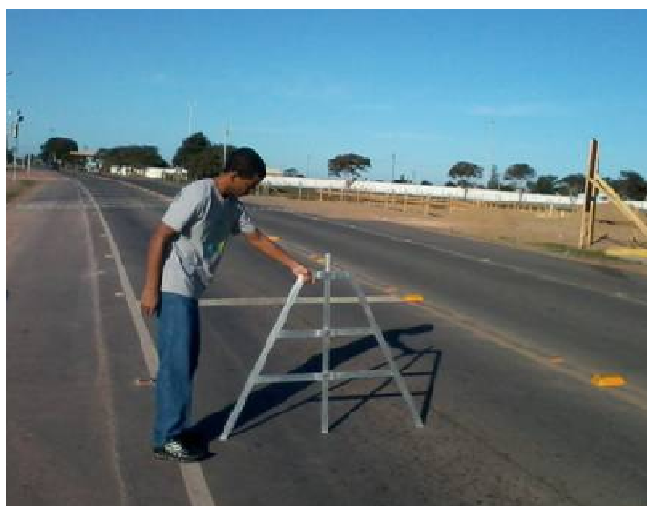
FIGURA 7.4: Ensaio de afundamento na trilha de roda.
