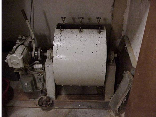
FIGURA 3.6: Equipamento Los Angeles.
