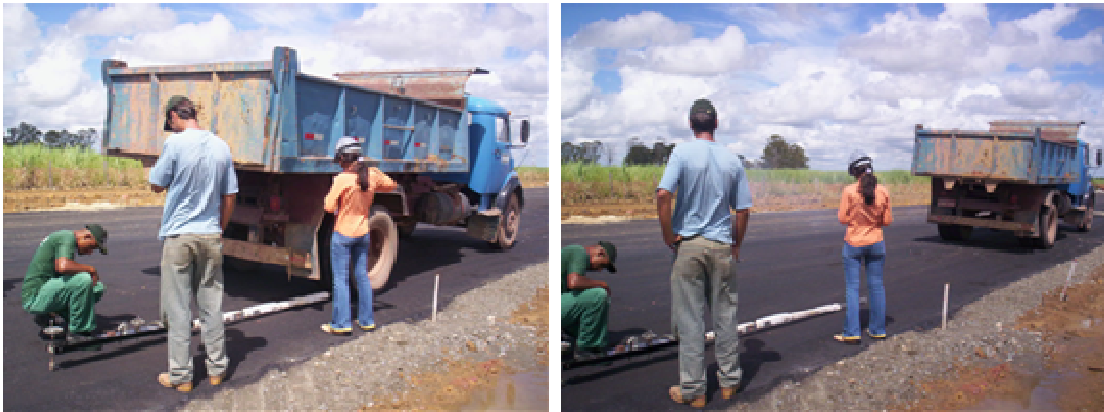
FIGURA 3.36: Medida de deflexão com a Viga Benkelman.
