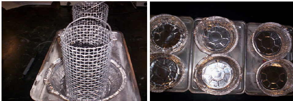
FIGURA 4.9: Ensaio de sensibilidade ao escorrimento.
