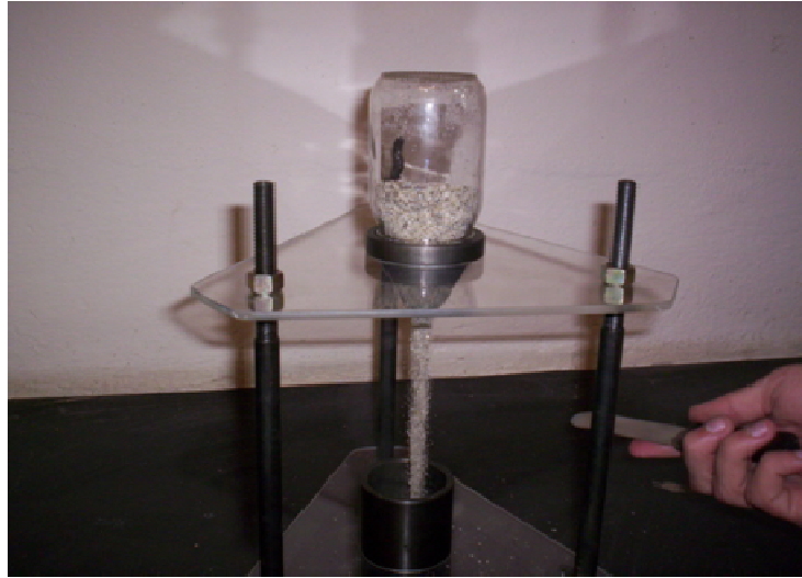
FIGURA 3.11: Ensaio de angularidade do agregado miúdo.
