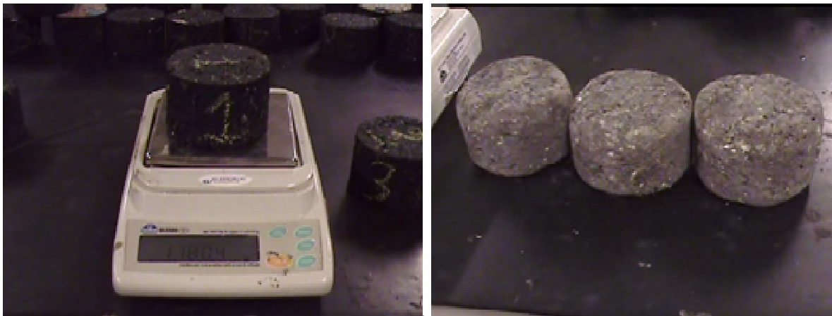
FIGURA 5.8: Corpos de prova antes e depois do ensaio desgaste Cantabro.
