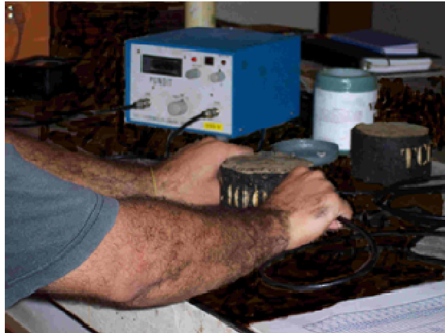
FIGURA 3.21: Ensaio de velocidade do pulso ultra-sônico.
