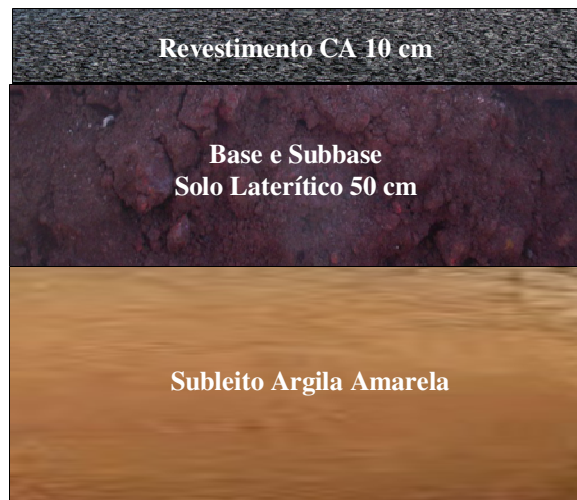
FIGURA 6.2: Estrutura típica da BR 356 trecho Campos – Atafona.
