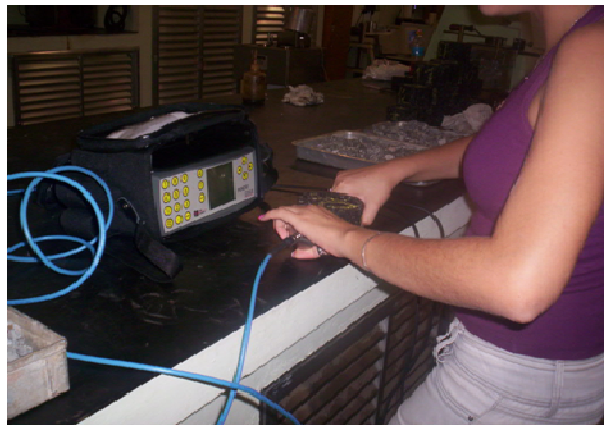
FIGURA 5.10: Ensaio de velocidade do pulso ultra- sônico.
