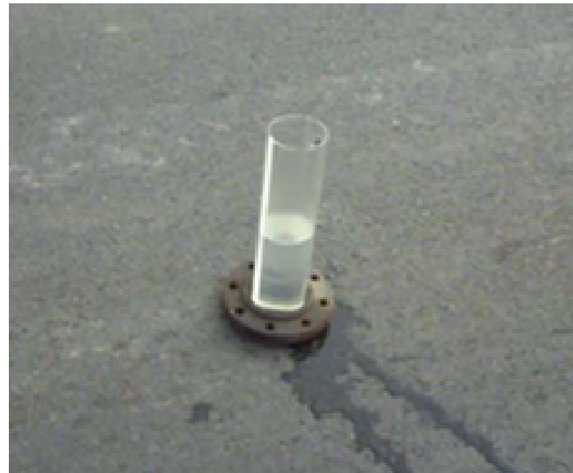
FIGURA 7.2: Ensaio de drenabilidade.
