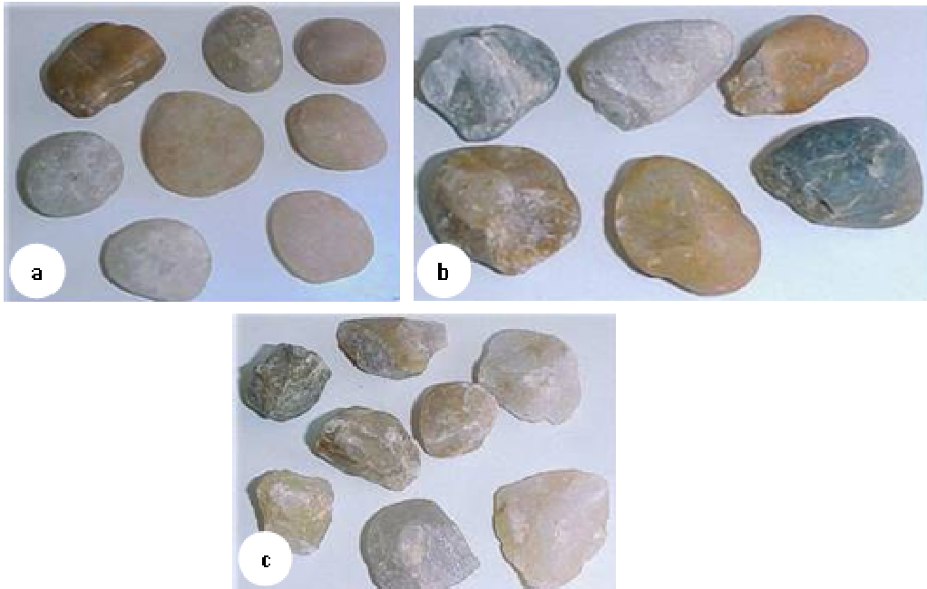
FIGURA 3.10: Partículas de agregado sem faces fraturadas (a), uma face fraturada (b), duas ou mais faces fraturadas (c).
