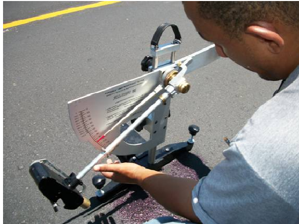
FIGURA 7.3: Ensaio de pêndulo britânico.
