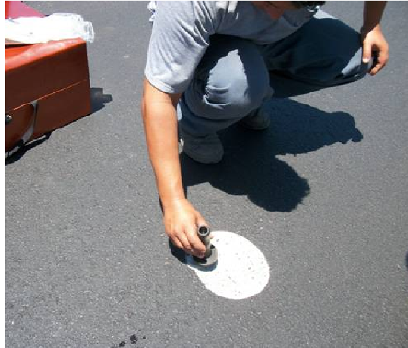
FIGURA 7.1: Ensaio de mancha de areia.
