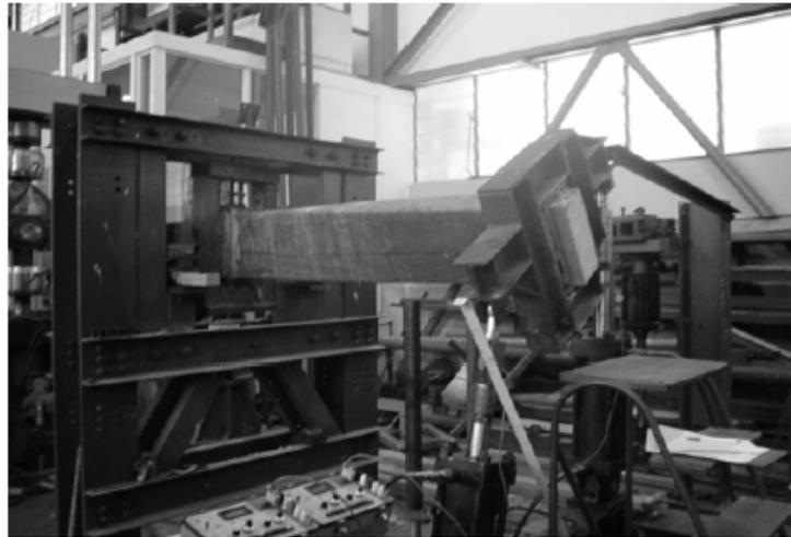
Figura 2.7 – Execução de ensaio à torção; AMELI *et al.* (2005).
