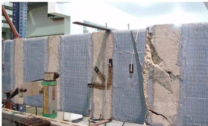
Figura 2.22 – Viga VT1 – localização da instrumentação; SILVA FILHO (2007).
