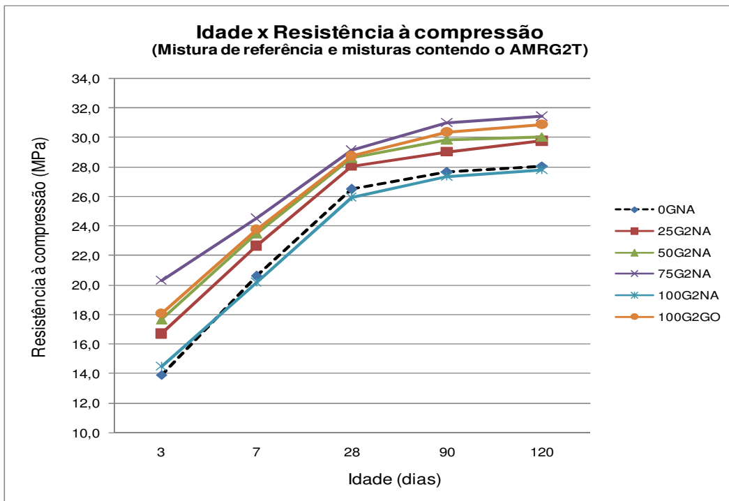
Figura 6.4: Resistência à compressão axial simples - mistura de referência x misturas contendo o AMRG2T.
