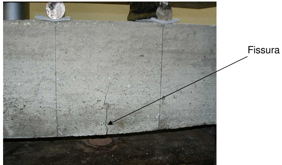
Figura 5.9: Aspecto da ruptura ocorrida no corpo de prova no ensaio de tração na flexão.
