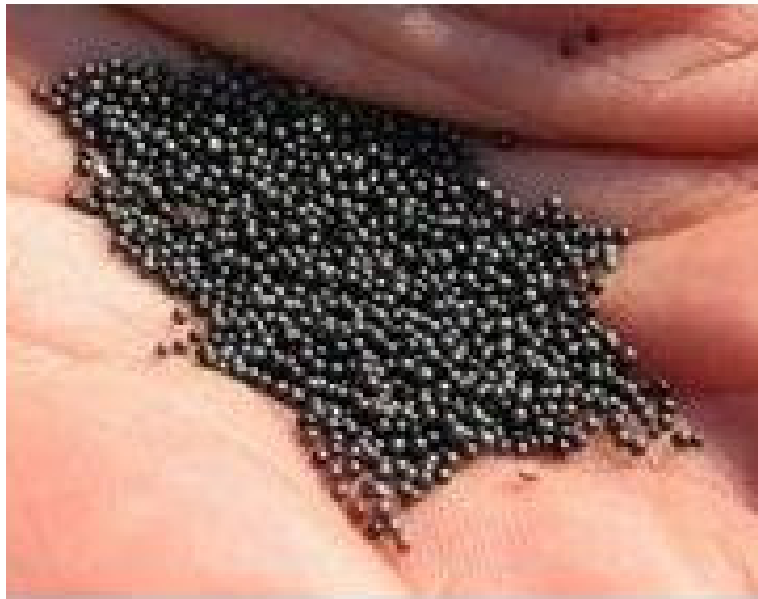
Figura 3.12: Granalha esférica de aço
