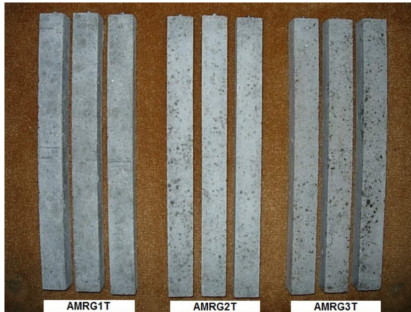
Figura 6.23: Aspecto físico das barras de argamassa após a realização do ensaio de RAA pelo método acelerado.
