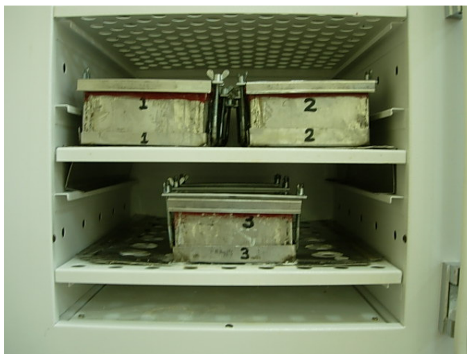
Figura 5.15: Recipientes contendo barras de argamassa imersas em solução de hidróxido de sódio (1,0 M) e colocados em estufa ventilada, a 80 °C, no ensaio de RAA.
