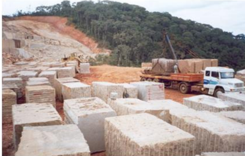
Figura 3.8: Carregamento de blocos utilizando “pau de carga”
