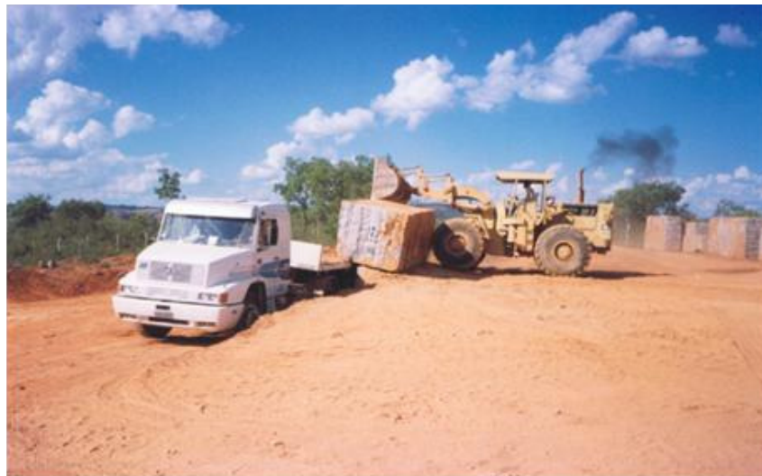
Figura 3.9: Carregamento de blocos por meio de rampa
