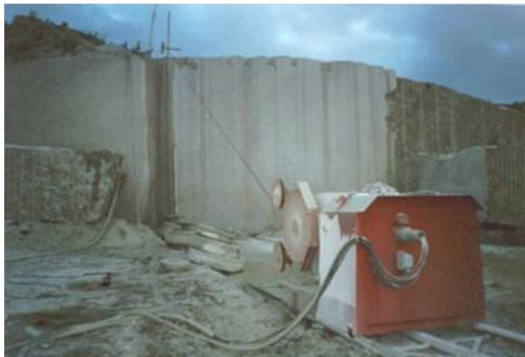
Figura 3.6: Corte de granito com fio diamantado
