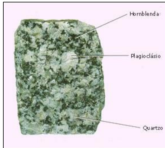
Figura 3.1: Exemplo de granito destacando três de seus minerais
