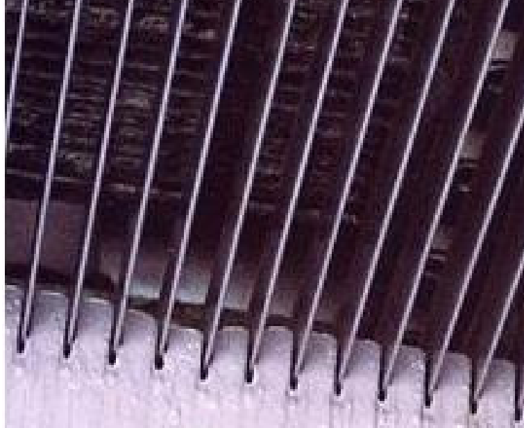
Figura 3.11: Lâminas de aço para corte de chapas de granito em tear
