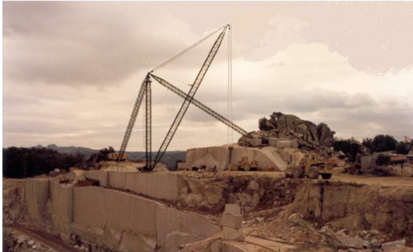
Figura 3.10: Carregamento de blocos utilizando de grua “derrick”
