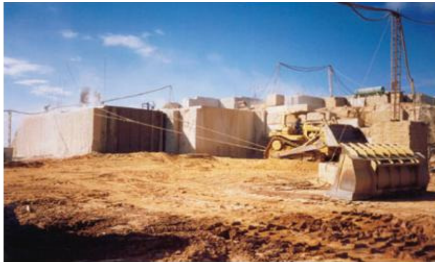
Figura 3.7: Deslocamento de bloco utilizando máquina robusta
