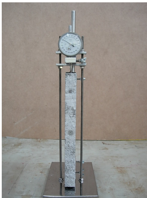
Figura 5.16: Medição da expansão do comprimento da barra de argamassa, no ensaio de RAA.
