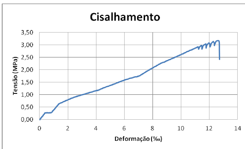
Figura A.II. 114: Curva cisalhamento-deformação do corpo-de-prova SNB1.
