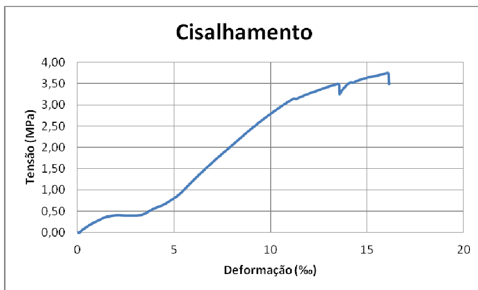
Figura A.II. 116: Curva cisalhamento-deformação do corpo-de-prova SNB3.
