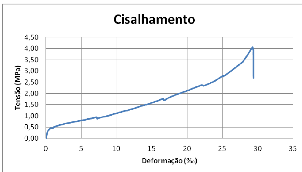
Figura A.II. 88: Curva cisalhamento-deformação do corpo-de-prova SNT3.
