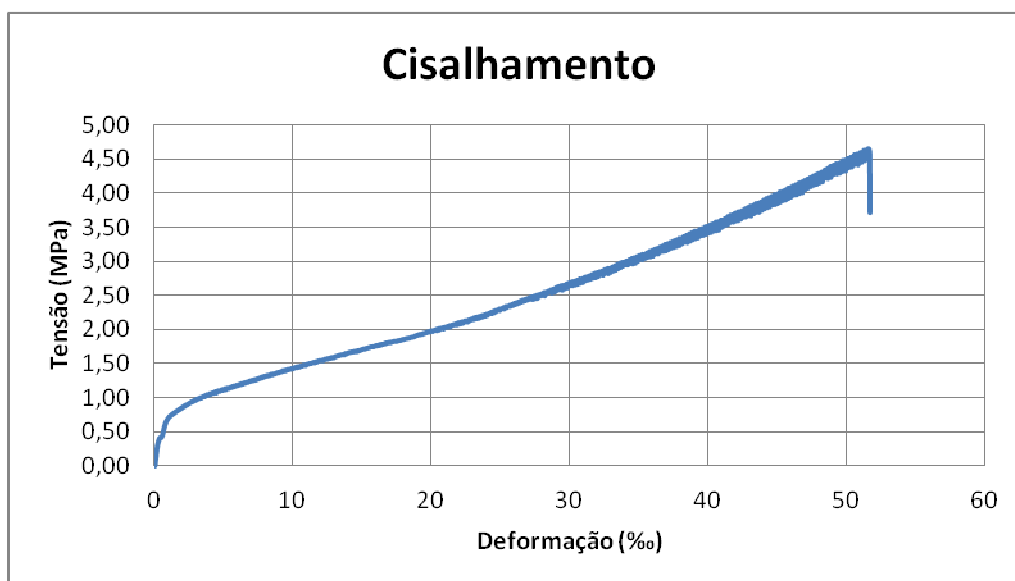
Figura A.II. 82: Curva cisalhamento-deformação do corpo-de-prova SNB3.
