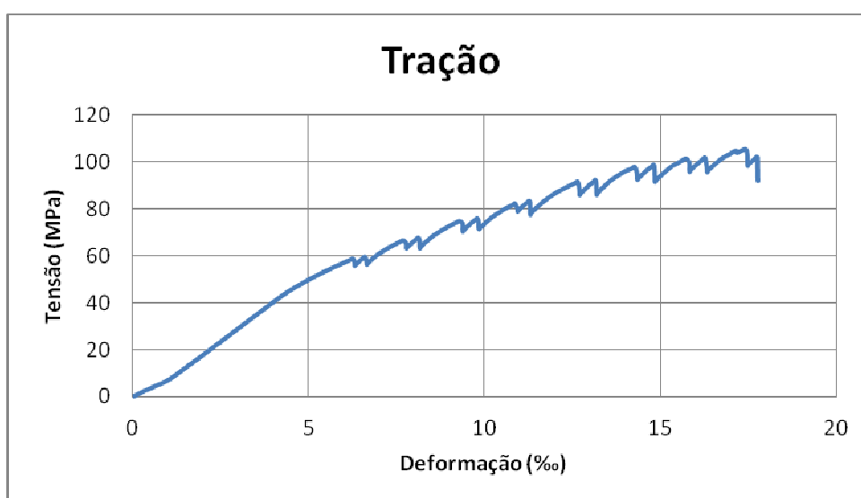
Figura A.II. 2: Curva tração-deformação do corpo-de-prova CNB2.
