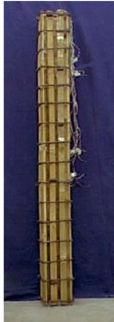
Figura 2.1: Armadura longitudinal de pilar em bambu. FERREIRA (2005).
