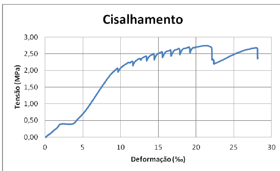
Figura A.II. 100: Curva cisalhamento-deformação do corpo-de-prova SNM1.
