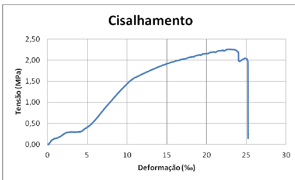
Figura A.II. 112: Curva cisalhamento-deformação do corpo-de-prova CNT2.
