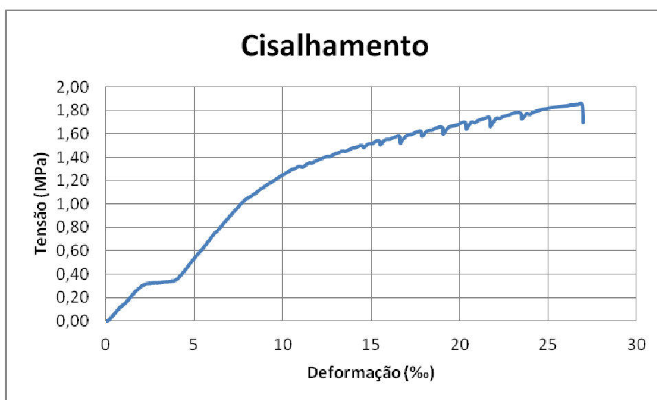
Figura A.II. 96: Curva cisalhamento-deformação do corpo-de-prova CNT3.
