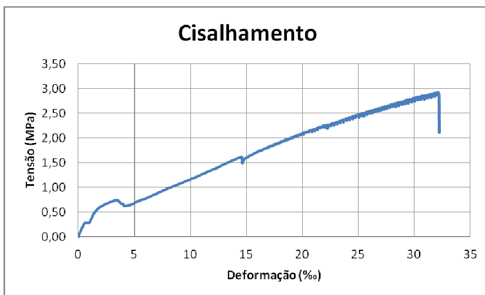
Figura A.II. 74: Curva cisalhamento-deformação do corpo-de-prova CNB1.
