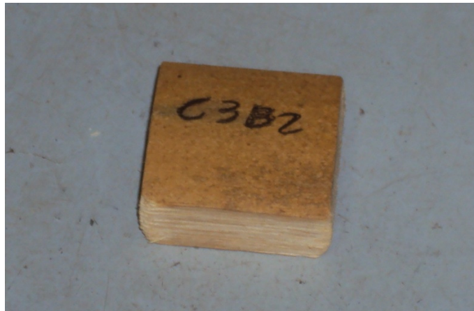
Figura 3.2: Corpo-de-prova para os ensaios de peso específico, teor de umidade natural, absorção de água e estabilidade dimensional.
