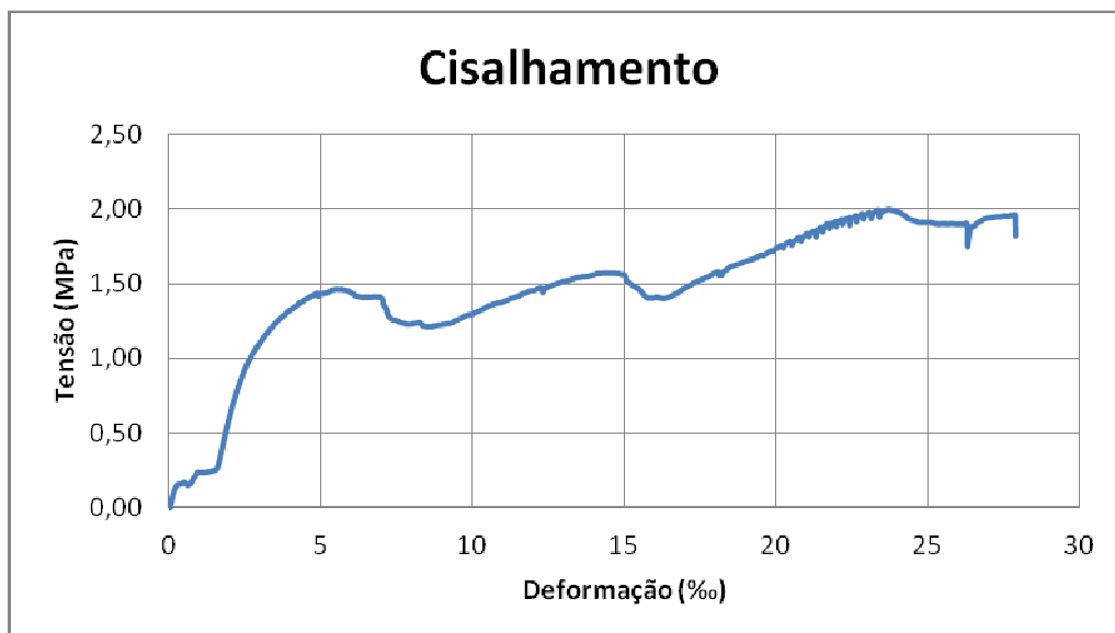
Figura A.II. 95: Curva cisalhamento-deformação do corpo-de-prova CNT2.
