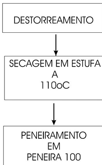
Figura 10.1 Fluxograma do processo de tratamento do rejeito.
