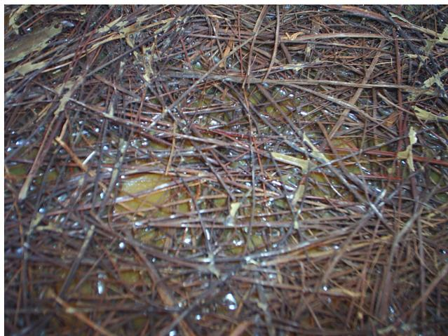
Foto 10.2 Fibras de piaçava segregadas na superfície do laminado
