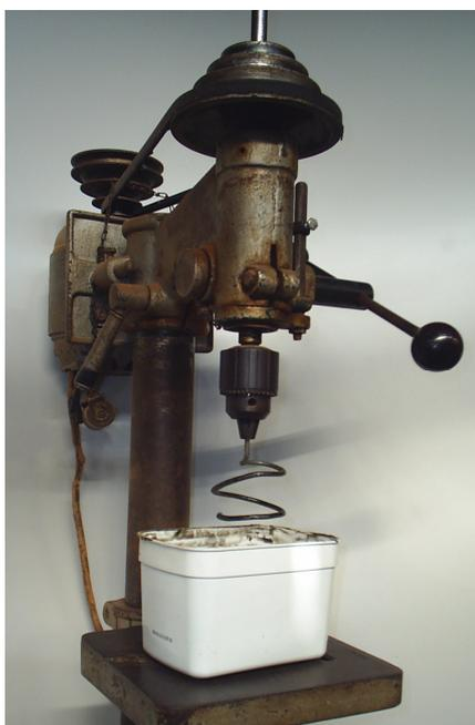
Foto 10.7 Misturador acoplado a furadeira de bancada
