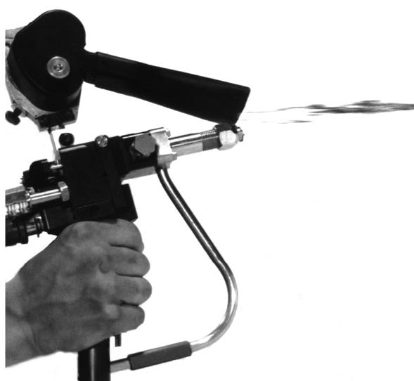
Foto 7.1 Pistola para processo de laminação spray up.
