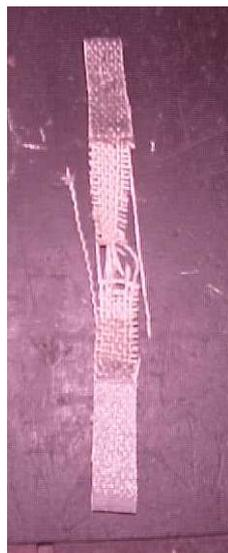
Foto 10.3 Corpo de prova de tecido rompido a tração.
