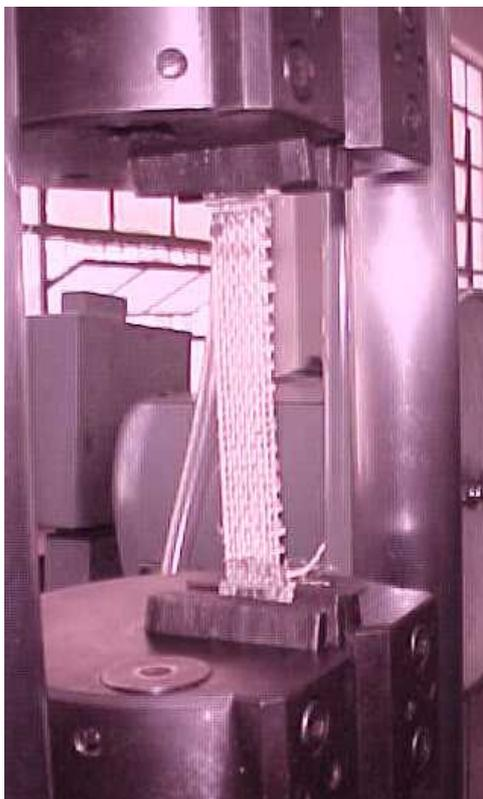
Foto 10.2 Corpo de prova fixado a máquina de tração.
