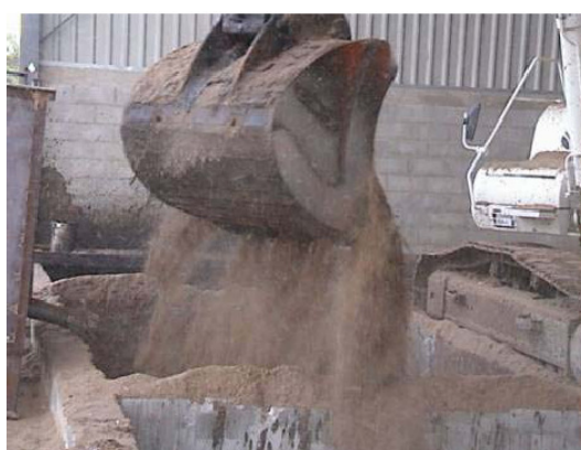
Figura 4.2: mistura de borra com serragem para queima em fornos de clínquer
