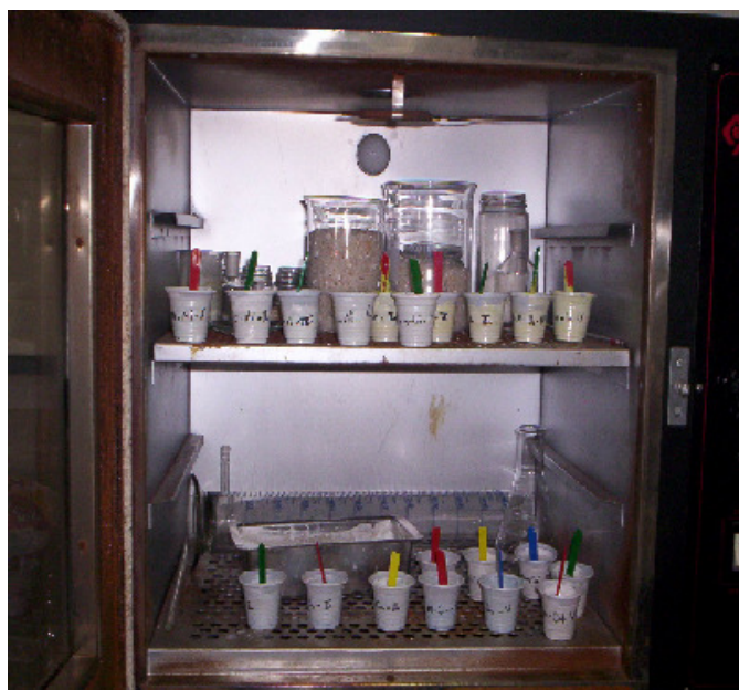
Figura 6.4: corpos-de-prova secando em estufa de laboratório
