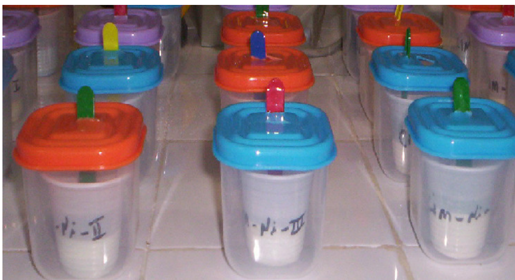
Figura 6.3: corpos-de-prova em recipientes de lixiviação
