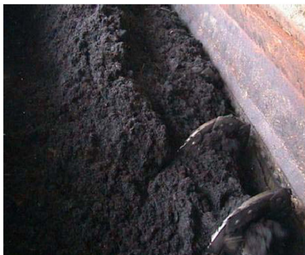
Figura 4.3: homogeneização de resíduos em misturador em parafuso
