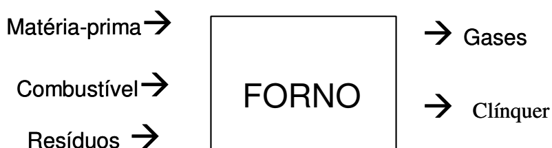
Figura 6.10: esquema básico de um forno de clínquer para queima de resíduos
