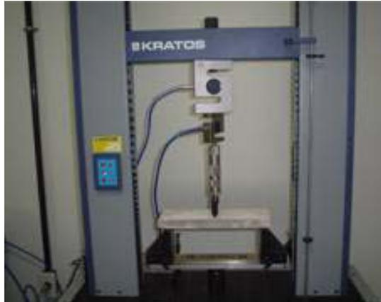
Figura 62: Esquemático do ensaio de flexão.
