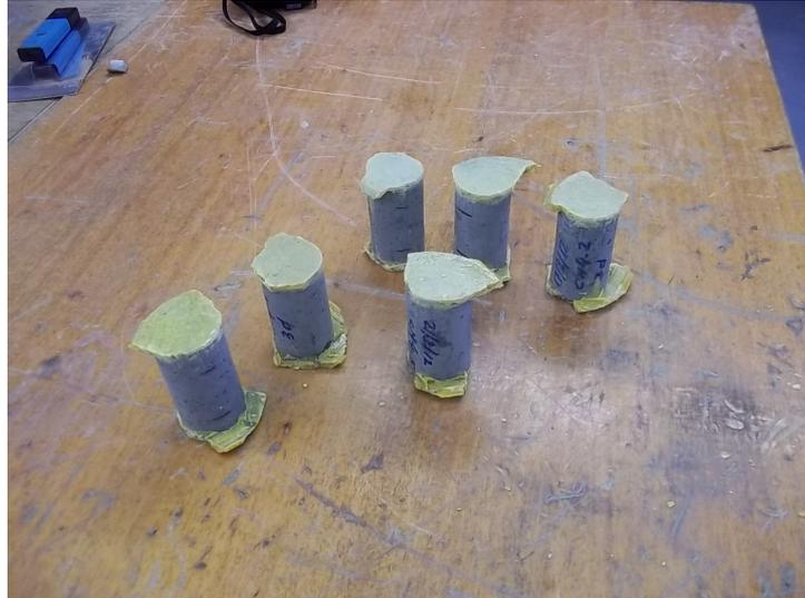
Figura 53: Corpos-de-prova após receberem capeamento de enxofre
