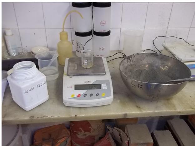
Figura 46: Pesagem do cimento, areia, água e aditivo.
