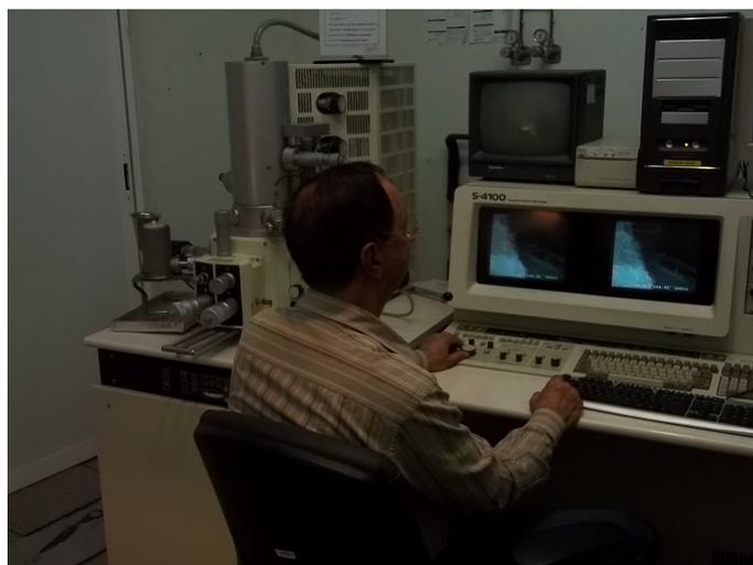
Figura 63: Microscópio Eletrônico de Varredura da UB.
