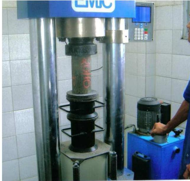
Figura 11: Equipamento para o ensaio de compressão.
