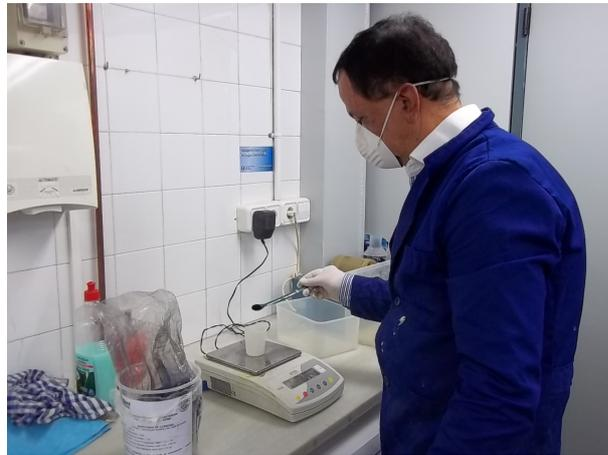
Figura 47: Pesagem do nanotubo de carbono.
