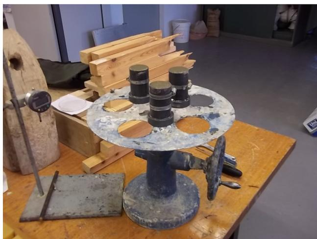
Figura 50: Moldagem e adensamento dos corpos de prova.
