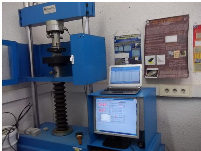
Figura 60: Ensaio de tração por compressão diametral.
