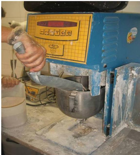
Figura 49: Vista da Betoneira onde a argamassa foi misturada.
