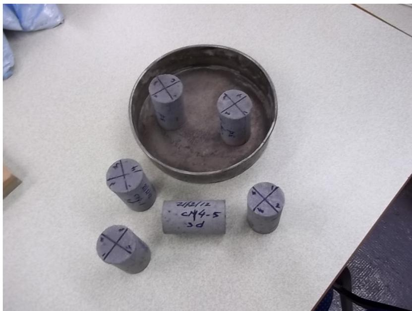
Figura 52: Corpos-de-prova desmoldados.
