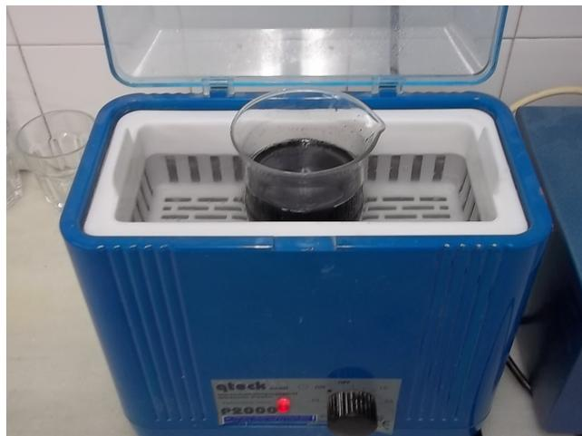
Figura 48: Mistura de água, aditivo e NTC sendo sonicada.
