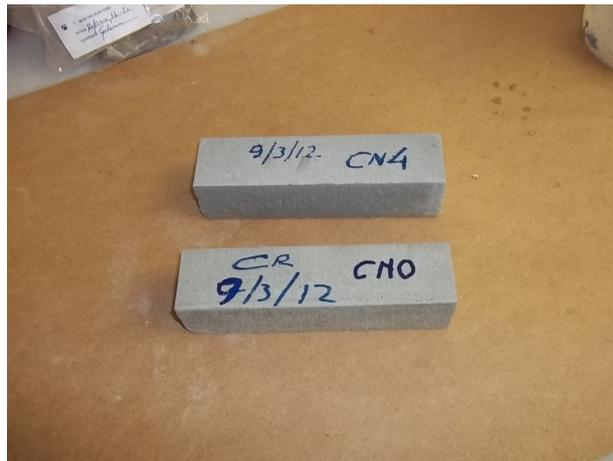
Figura 61: Corpos-de-prova usados no ensaio de flexão.
