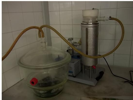
Figura 65: Processo de medição de porosidade.
