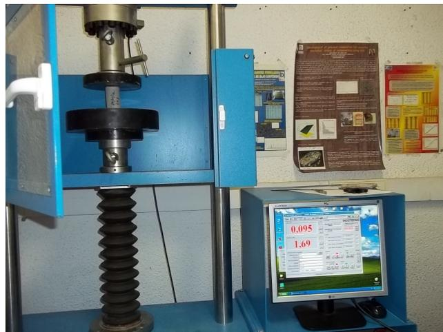
Figura 59: Prensa usada para os ensaios de resistência à compressão
