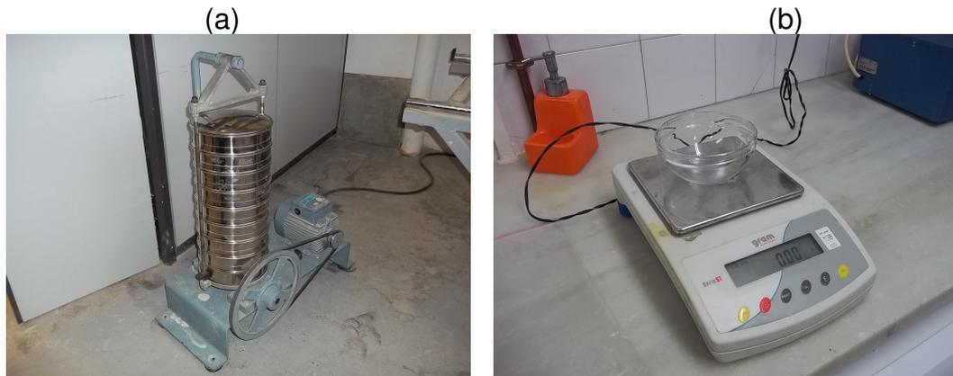
Figura 43: A fig.(a) mostra o momento do peneiramento e a fig.(b), o processo de pesagem dos grãos.
