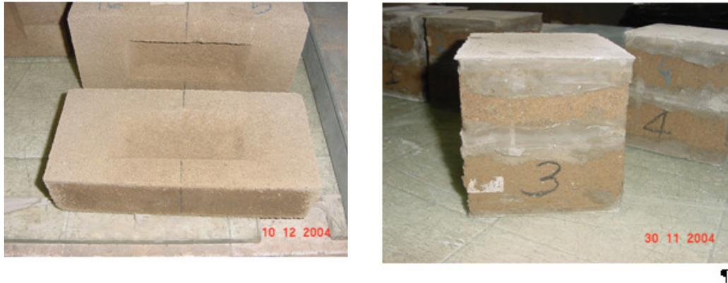
Figura 5.4 - Corpos de prova preparados para o ensaio de resistência à compressão
