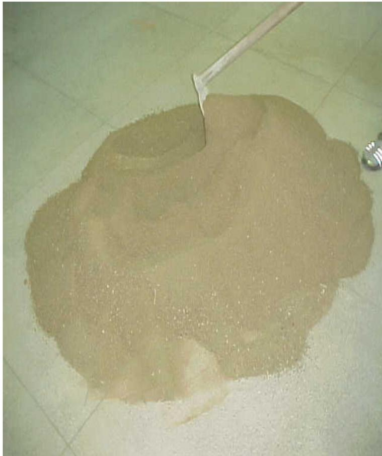
Figura 5.6 - Homogeneização do solo com o cimento
