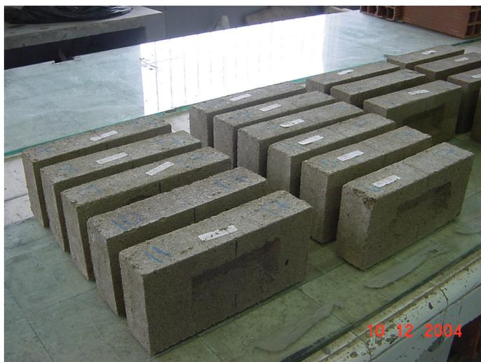
Figura 5.3 - Tijolos após prensagem manual
