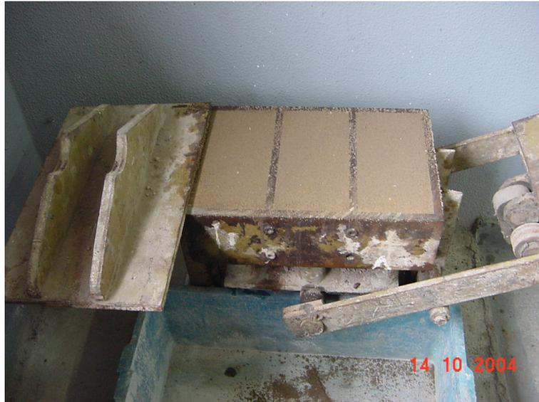
Figura 6.19 - Máquina de prensagem manual
