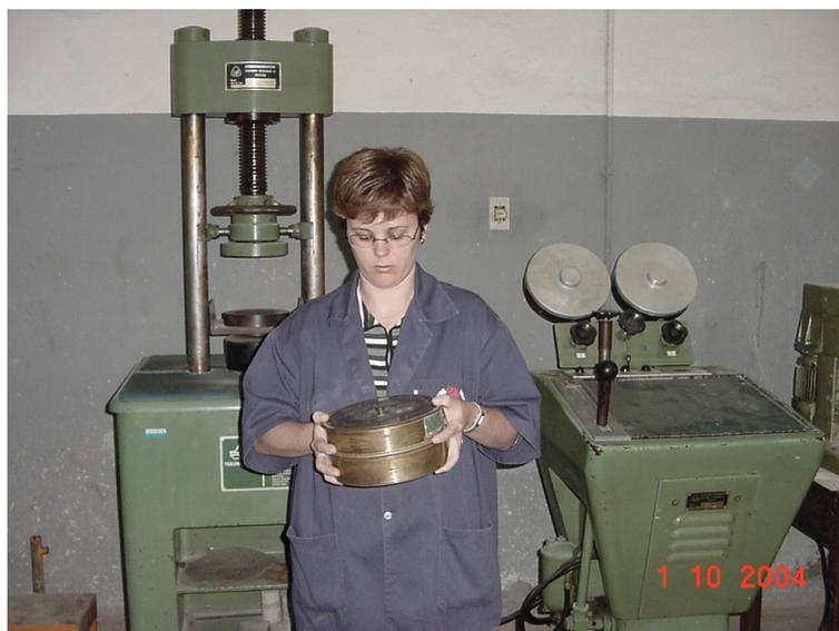
Figura 6.6 - Ensaio de granulometria
