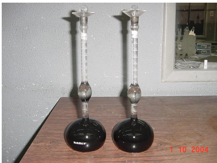
Figura 6.4 - Massa Específica dos materiais em pó
