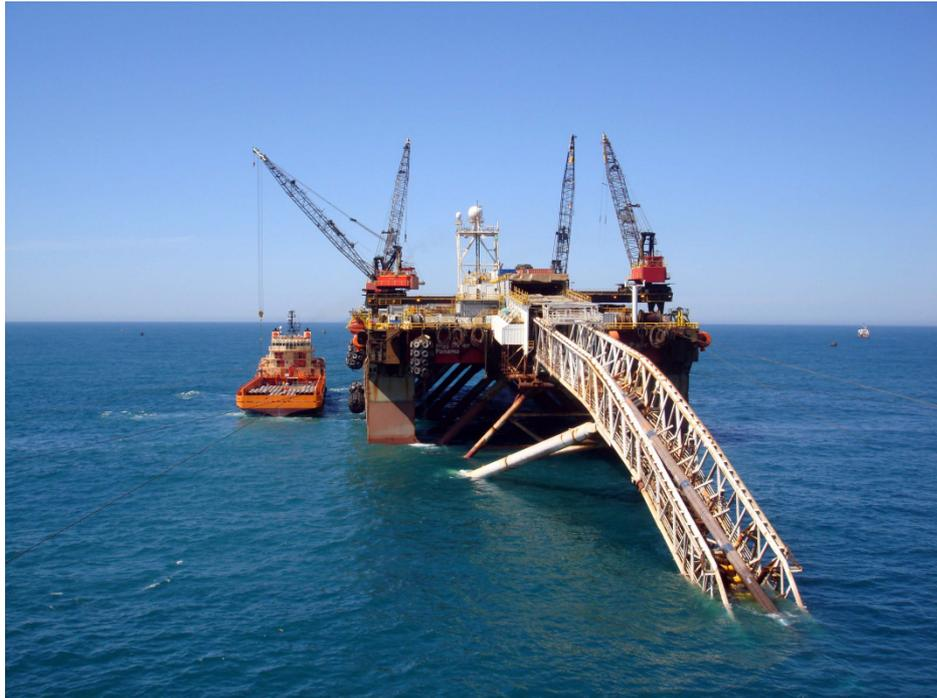
Figura 2.6: Embarcação típica para instalação *S-Lay*.
