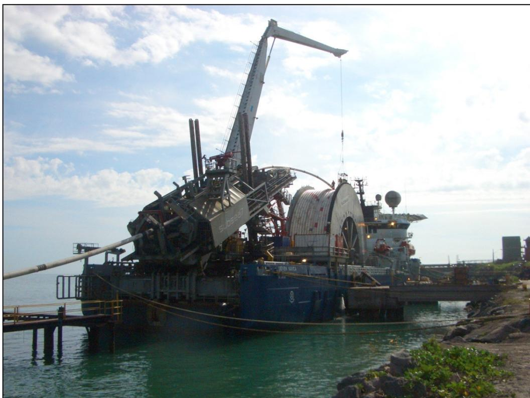
Figura 6.3: Embarcação de *reel-lay* durante o spooling da linha.
