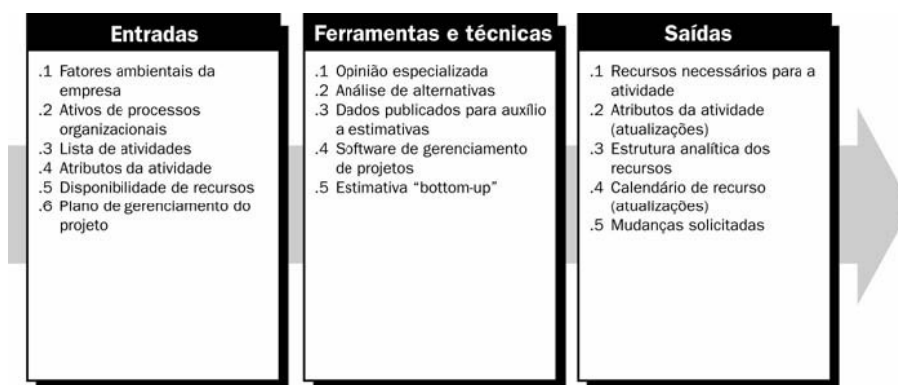
Figura 2.24 - Estimativa de recursos da atividade: Entradas, ferramentas e técnicas, e saídas
