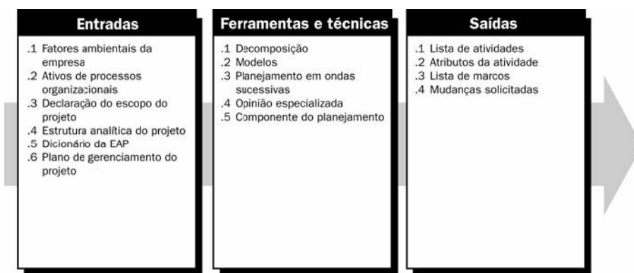
Figura 2.20 - Definição da atividade: Entradas, ferramentas e técnicas, e saídas.
