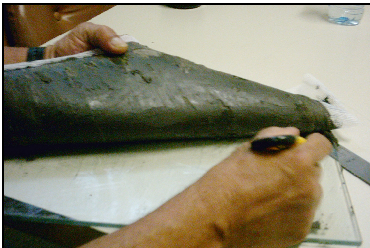
Figura 3.21 – Falha na remoção do sistema de impermeabilização aplicado sobre o vidro com free coat (vaselina)
