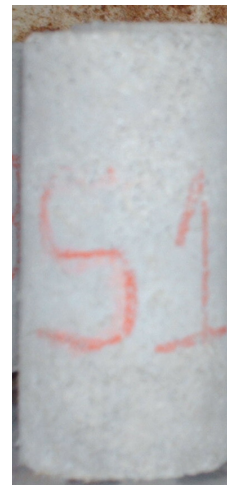
Figura 3.10 - Corpos-de-prova cilíndricos com fibras de sisal cortadas
