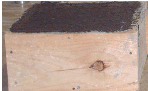
Figura 3.8 - Corpos-de-prova prismático com estruturante em sisal
