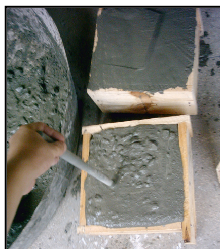
Figura 3.15 - Adensamento e nivelamento da concretagem
