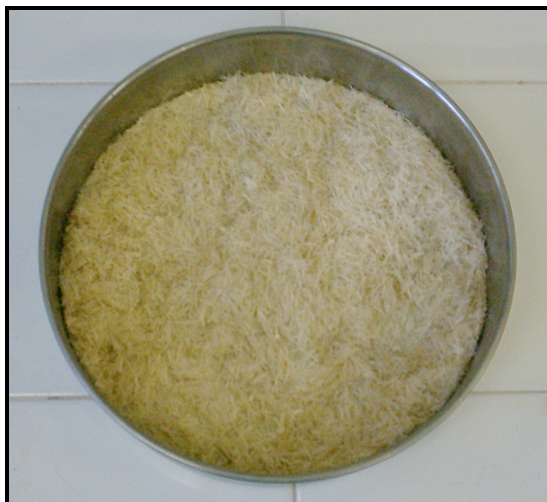
Figura 3.3 – Fibras provenientes da: espécie Agave Sisalana (sisal) – 5 mm.
