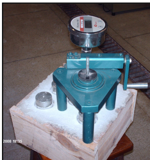
Figura 3.17 - Equipamento usado no Ensaio de Aderência
