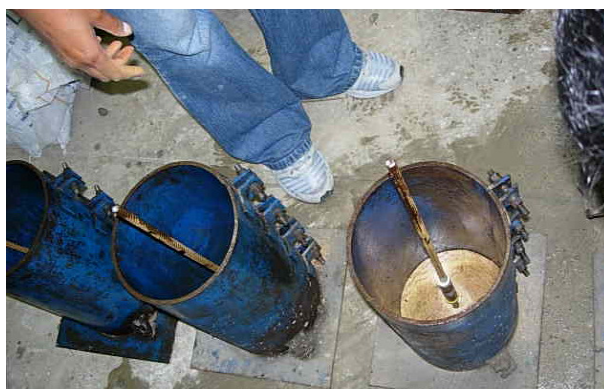
Figura 45 : Formas do ensaio de arrancamento.
