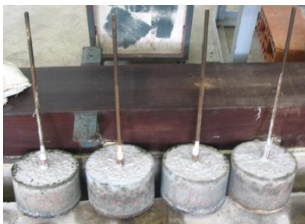
Figura 46 : CP do ensaio de arrancamento.
