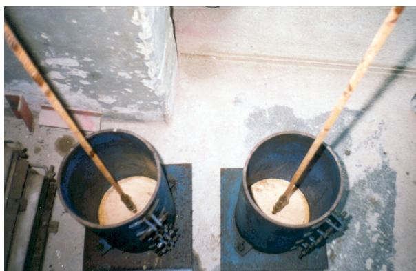
Figura 37: Formas cilíndricas do ensaio de arrancamento.
