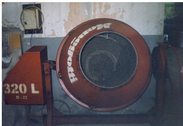
Figura 29: Betoneira utilizada na confecção dos traços.
