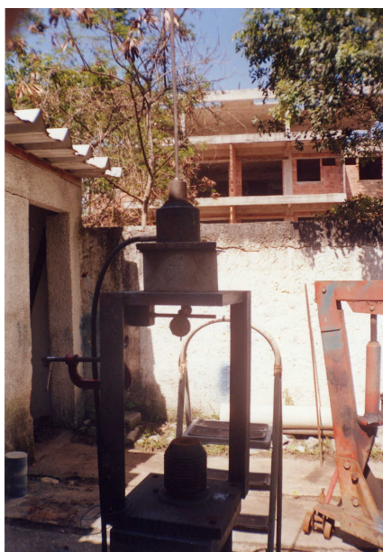
Figura 40: Execução do ensaio de arrancamento.
