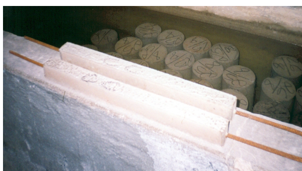
Figura 35: Corpos-de-prova para o ensaio de conformação superficial.
