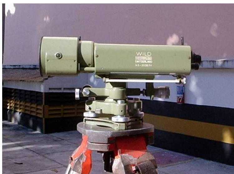
Figura 2.9 – Nível óptico-mecânico Wild N3.
