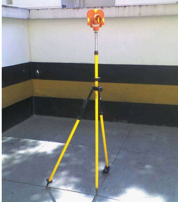
Figura 2.15 – Exemplo de alvo (prisma refletor), bastão telescópico e bipé.
