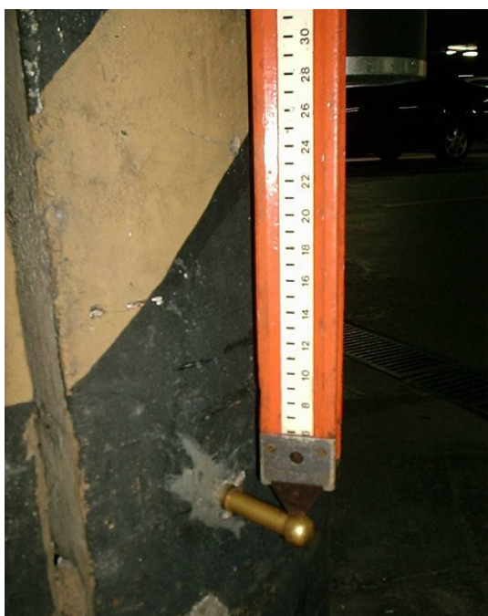
Figura 2.12 – Mira de ínvar apoiada em pino.
