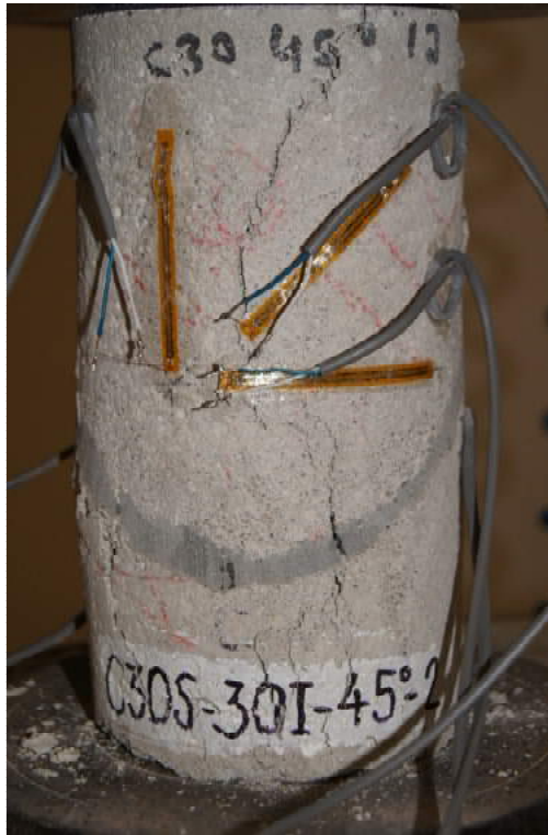
Figura 5.22 – C30S-30I-45-02 após a ruptura.
