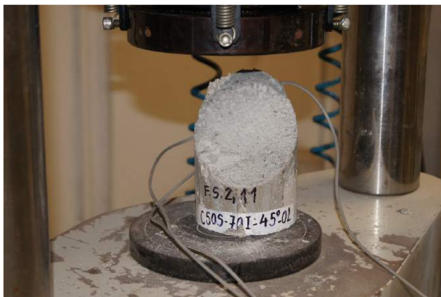
Figura 5.24 – C50S-70I-45-02 após a ruptura com rompimento na junta de colagem.
