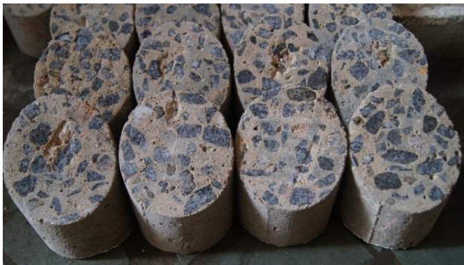
Figura 4.15 – Peças de C30 cortadas com inclinação a 30° prontas para colagem.
