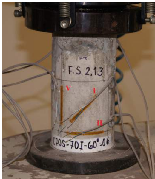
Figura 4.8 – Instrumentação para determinação da tensão de aderência, sendo uma roseta por hemisfério, na altura média e diametralmente opostas.
