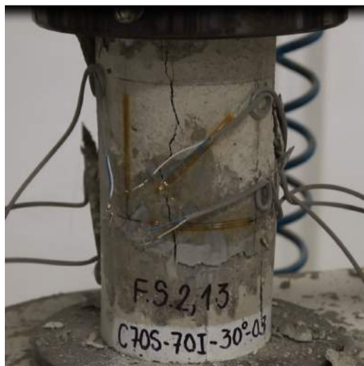
Figura 5.23 – C70S-70I-30-03 após a ruptura.
