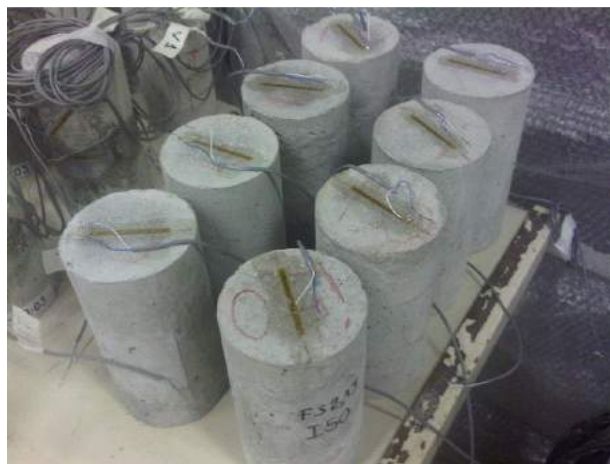
Figura 4.7 – Instrumentação para aquisição dos parâmetros da TRU.
