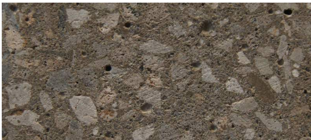
Figura 5.21 – Superfície a ser colada com rugosidade do elemento C70-60-01.
