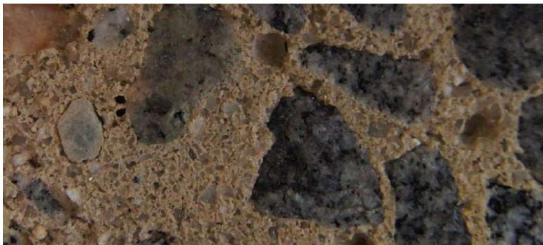
Figura 5.19 – Superfície a ser colada com rugosidade do elemento C30-30-04.
