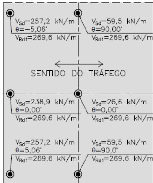
Figura 3.15– Forças cortantes de dimensionamento e resistentes no modelo 1 ( $e=0^\circ$ )
