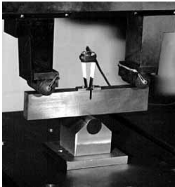
Figura 0.4: Prensa hidráulica para ensaio de tenacidade com corpo de prova SENB.
