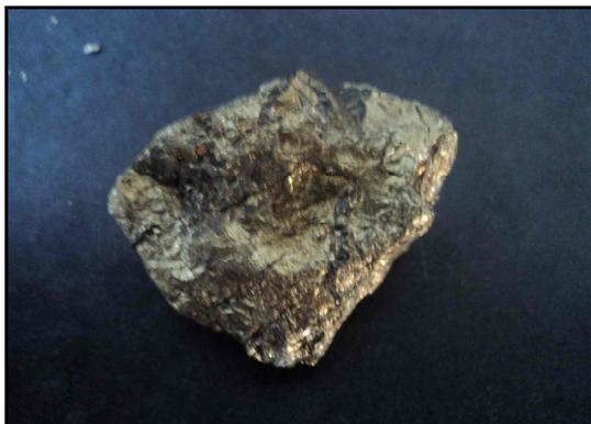
Figura 95: Amostra de bornita e calcopirita
