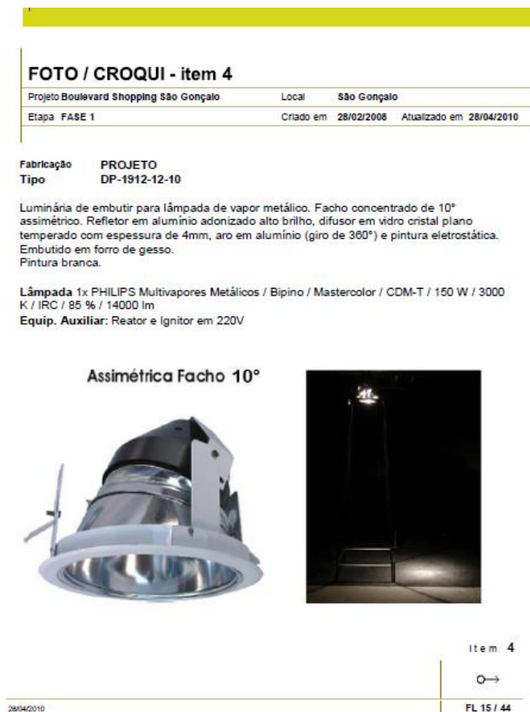
Figura 34: Caderno de especificação – características técnicas da luminária
