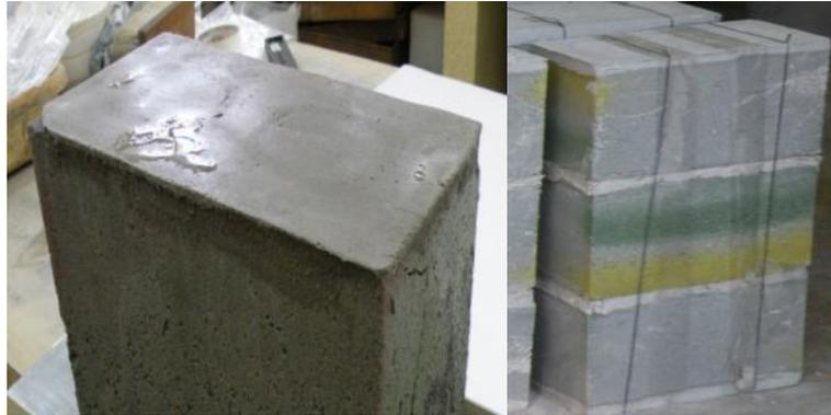
Figura 4.19: Capeamento dos blocos de concreto.
