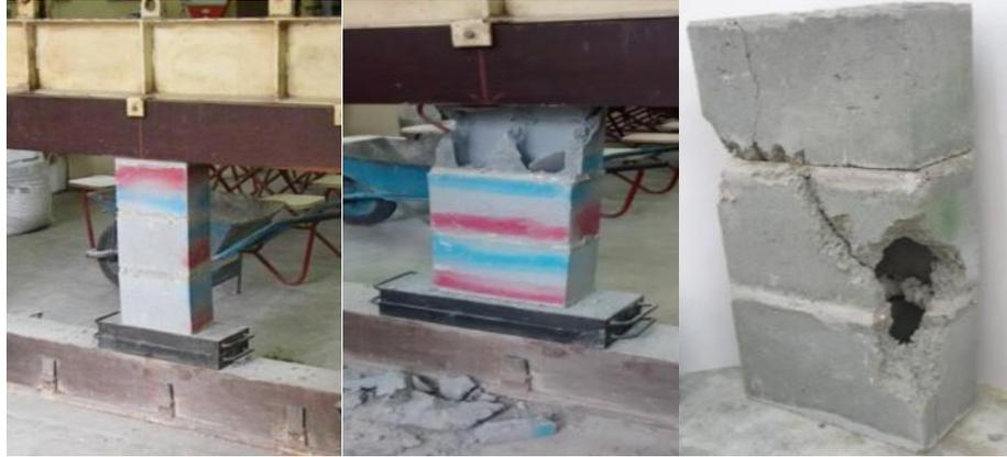
(a) Início do ensaio      (b) Rompimento      (c) Prisma rompido
