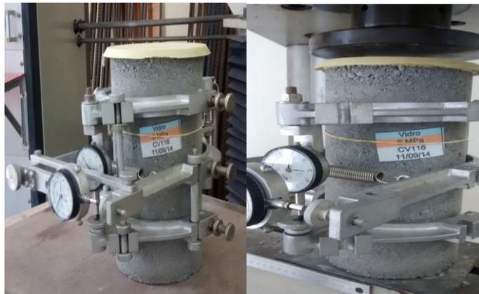
Figuras 4.25: Ensaio do Coeficiente de *Poisson* do concreto.
