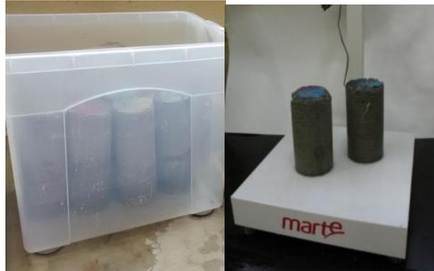
(a)Corpo de prova imerso(b) Pesagem
