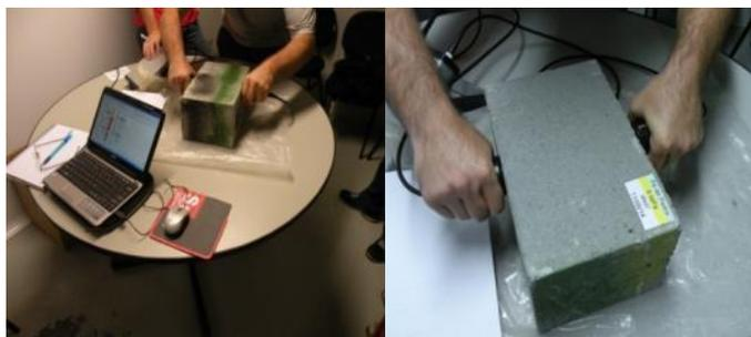
Figura 4.30: Ensaio de velocidade de propagação ultrassônica em blocos de concreto com AMN e AMVT.
