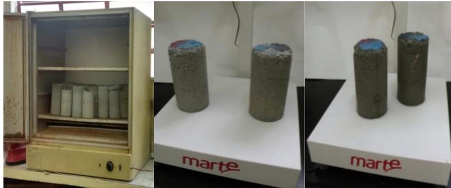
Figura 4.26: Ensaio de absorção por imersão do concreto.
