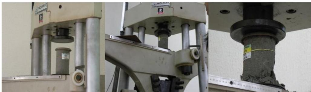
Figura 4.20: Ensaio de resistência à compressão axial do corpo de prova cilíndrico.
