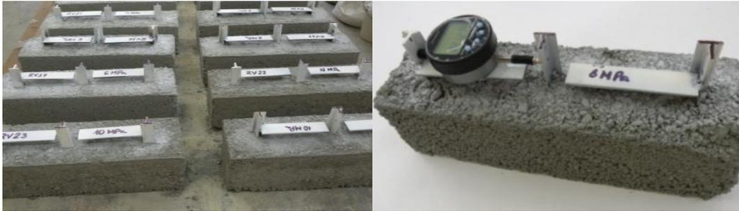
Figura 4.22: Ensaio de retração hidráulica do concreto.
