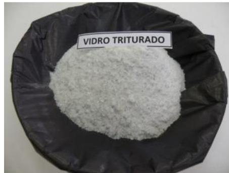
Figura 4.5: Vidro na granulometria do pó de pedra para ser encaminhado à indústria de fabricação dos blocos.
