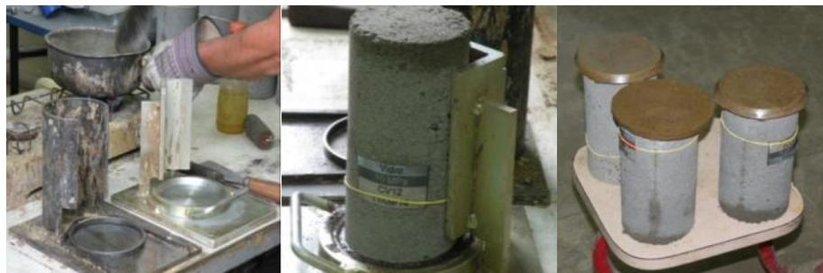
(a) Preparação do enxofre (b) Guia de perpendicularidade (c) CP capeados
