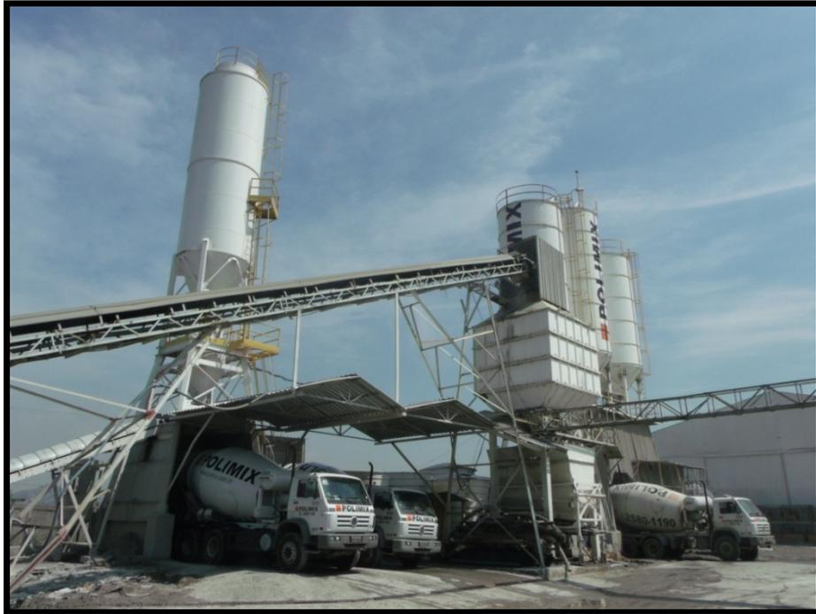
**Figura 16:** Central dosadora de concreto
