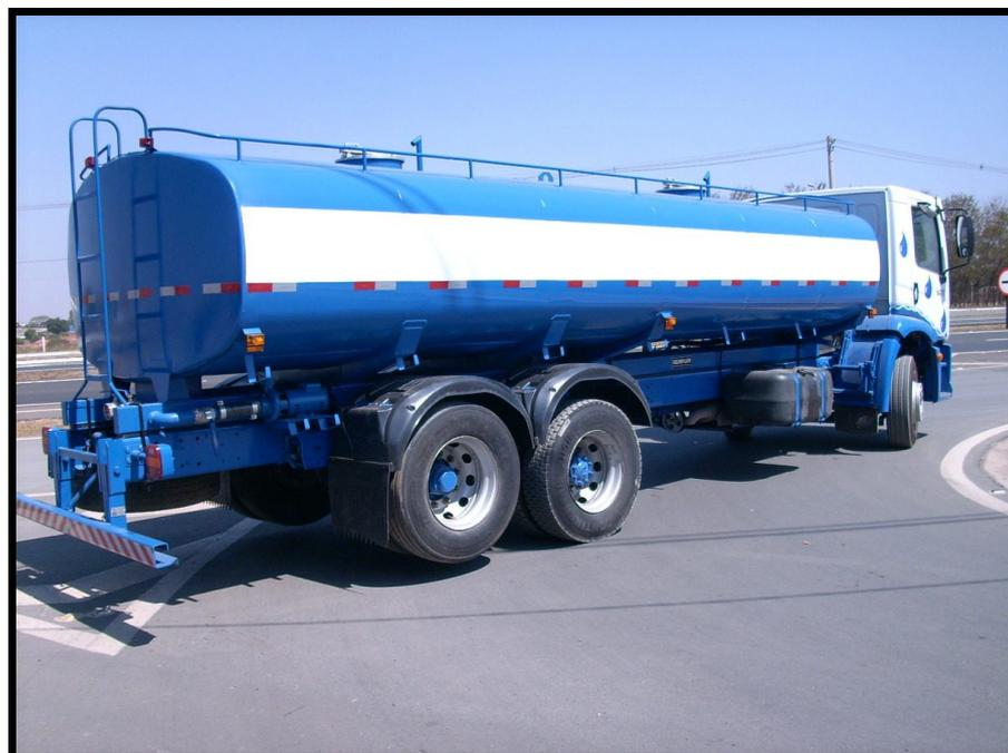
**Figura 19:** Caminhão-pipa de capacidade de 20.000 l
