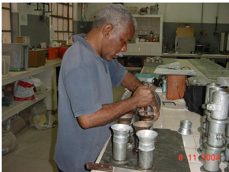
Figura 6.14 - Moldagem dos corpos de prova
