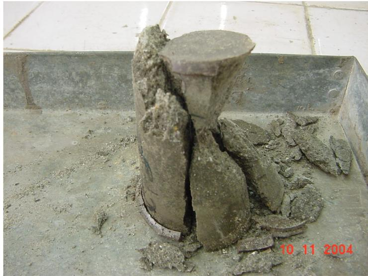
Figura 6.15 - Corpo de prova após ser submetido ao ensaio de compressão axial
