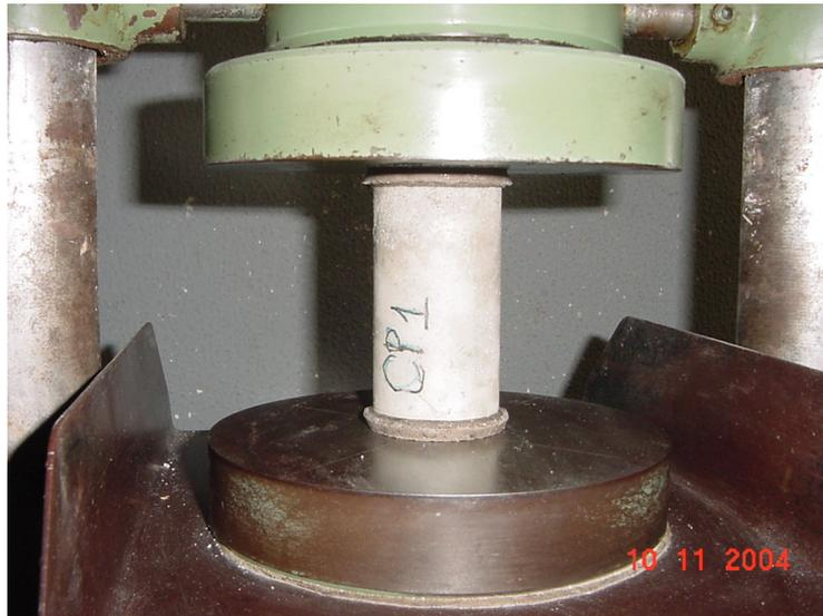
Figura 4.3: Ensaio de resistência à compressão de argamassa
