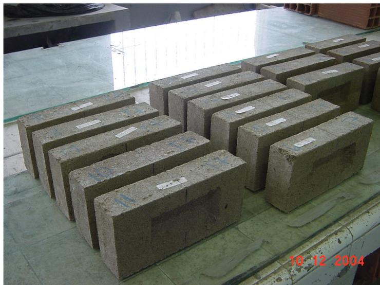
Figura 6.20 - Corpos de prova após moldagem
