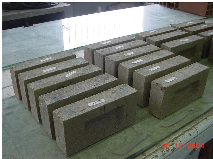
Figura 5.3: Tijolos após prensagem manual
