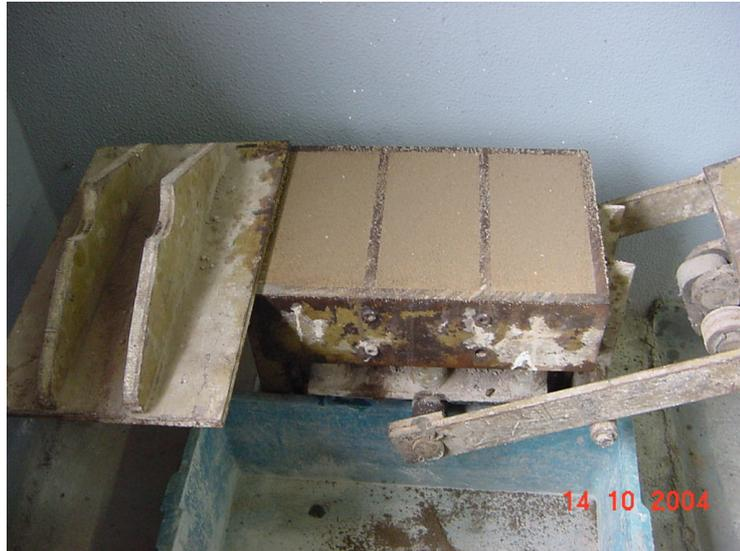
Figura 6.19 - Máquina de prensagem manual
