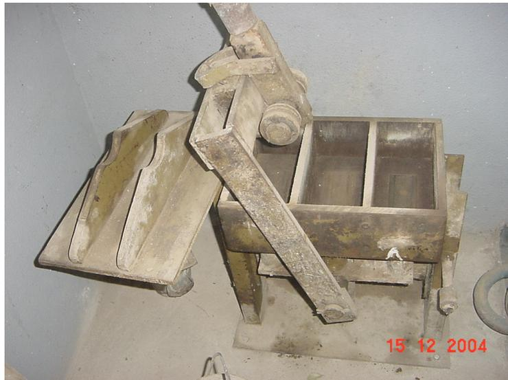
Figura 5.2: Prensa manual utilizada na moldagem dos tijolos
