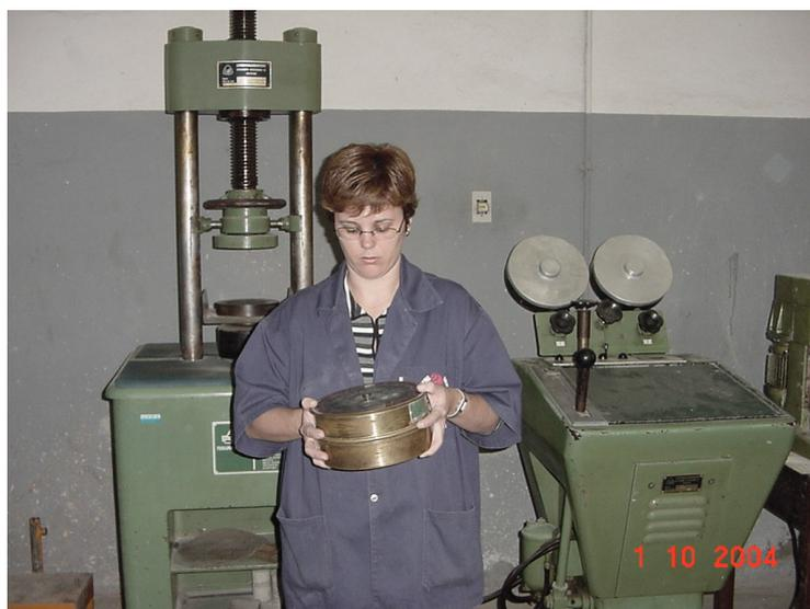
Figura 6.6 - Ensaio de granulometria
