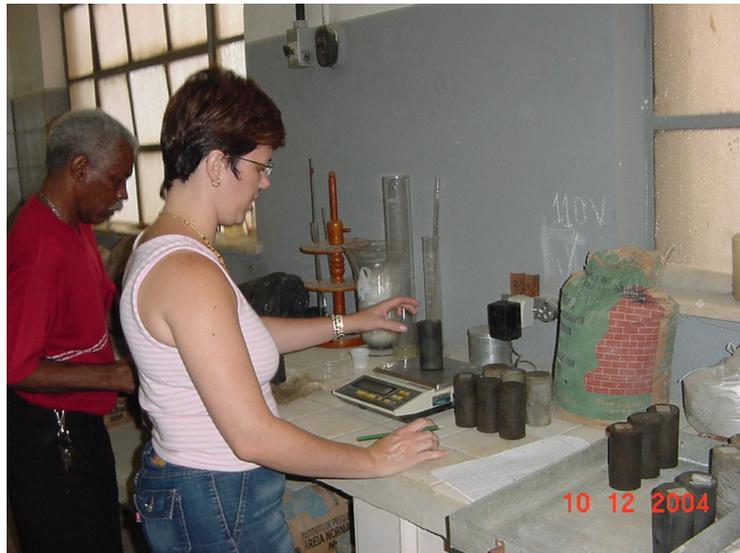
Figura 6.16 - Pesagem dos corpos de prova para o ensaio de absorção
