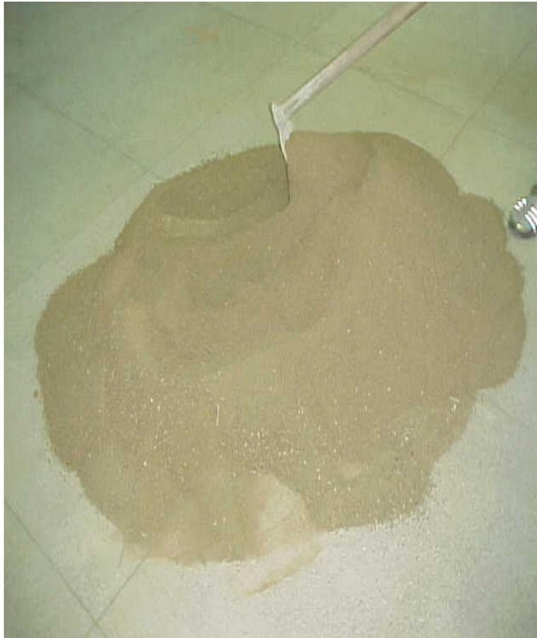
Figura 5.6: Homogeneização do solo com o cimento
