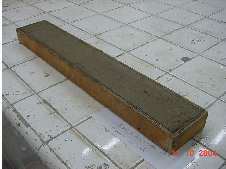
Figura 5.7 - Teste da caixa para verificar a retração do solo
