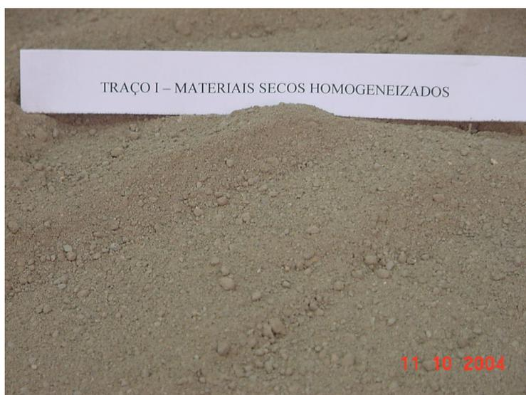
Figura 5.1: Mistura para moldar tijolos de solo/cimento
