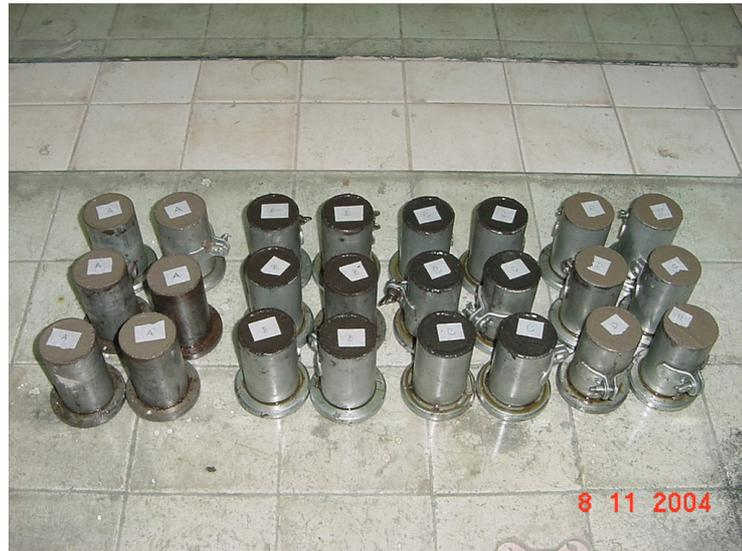
Figura 4.2: Argamassa moldada em fôrmas cilíndricas (50 x 100)mm
