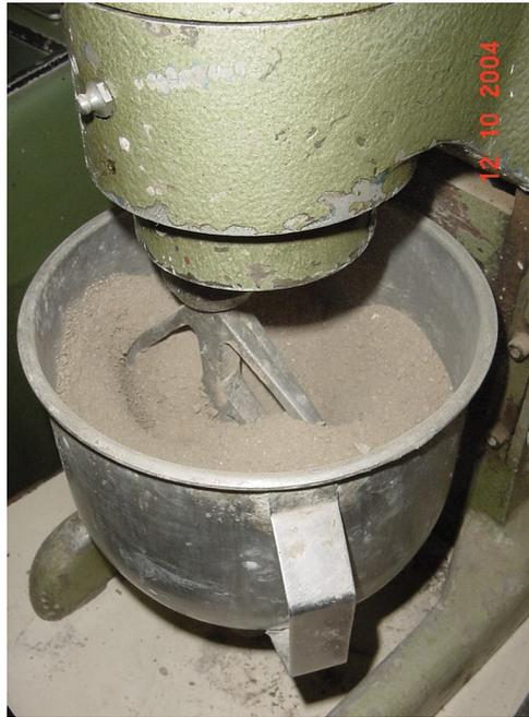
Figura 6.18 - Mistura mecânica na adição da cinza e do cimento
