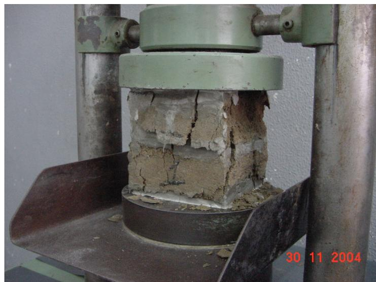
Figura 5.5: Ruptura do corpo de prova capeado
