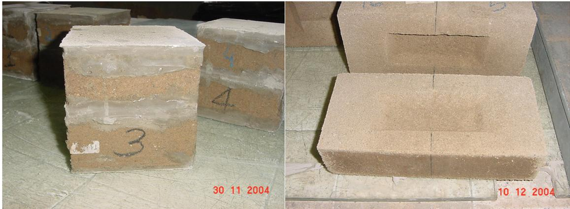
Figura 5.4: Corpos de prova preparados para o ensaio de resistência à compressão
