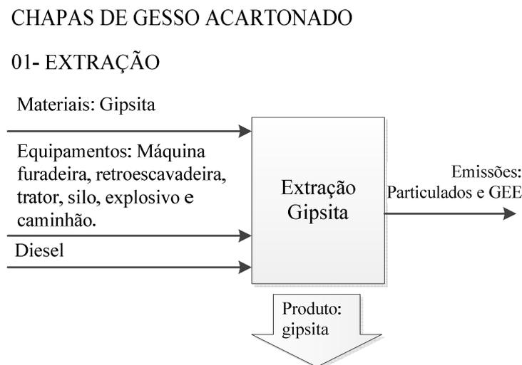
Figura 0.27 – Modelagem de extração da gipsita.
