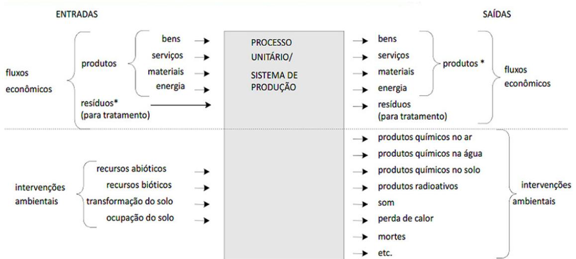
Figura 0.8 – Modelo de entradas e saídas de um Inventário de Ciclo de Vida.
