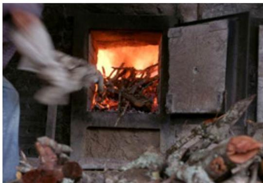
Figura 0.41 – Forno a lenha para calcinação.
