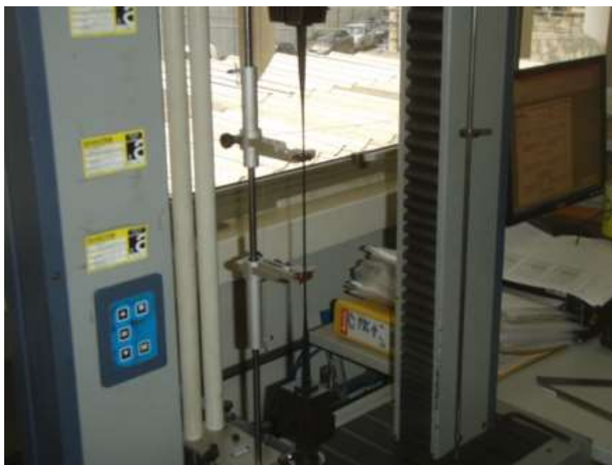
Figura 3.17 – Ensaio de tensão e alongamento de ruptura a tração.
