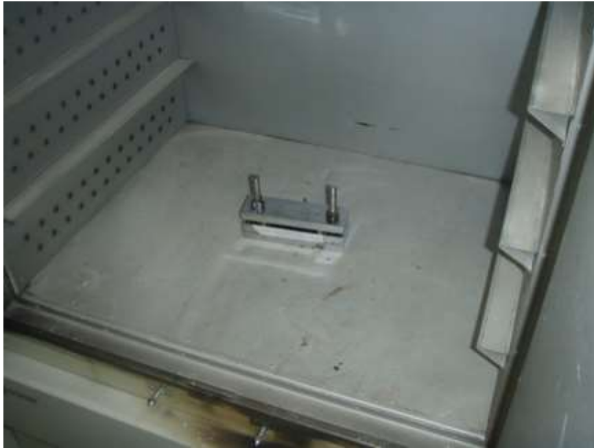
Figura 3.18 – Ensaio de deformação permanente a compressão.
