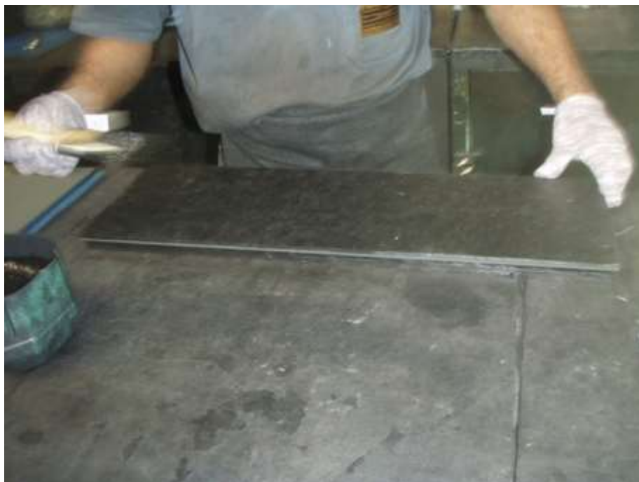
Figura 3.11 – Montagem do sanduíche borracha/chapa de aço.
