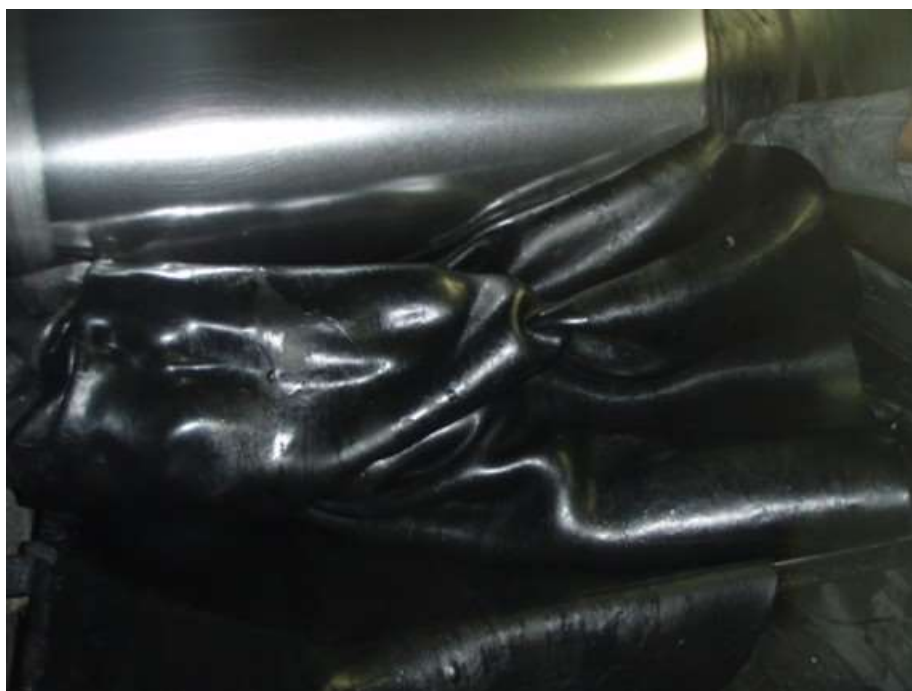
Figura 3.8 – Mistura acelerada em fase de laminação.
