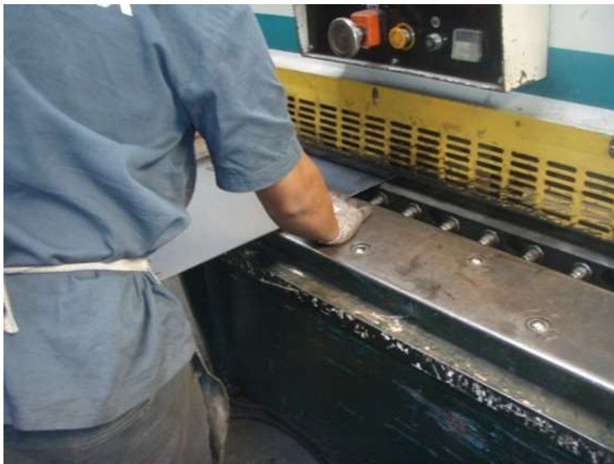
Figura 3.9 – Corte das chapas de aço em guilhotina.
