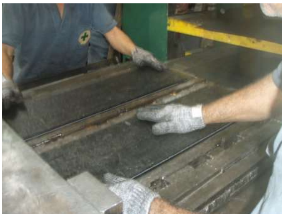
Figura 3.12 – Colocação do sanduíche borracha/chapa de aço nos moldes metálicos.
