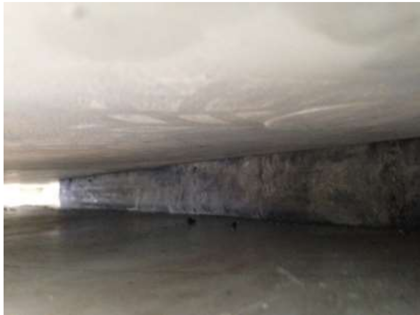
Figura 6.7 – Aparelho de apoio dentro do aparato de ensaio, com tensão de 40 MPa.
