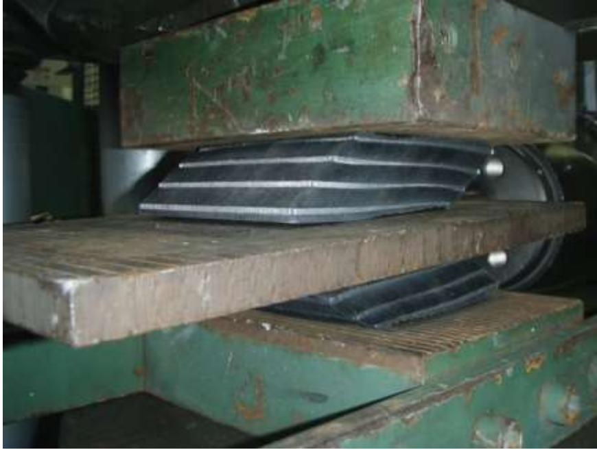
Figura 3.20 – Ensaio de distorção – resistência ligação elastômero - aço.
