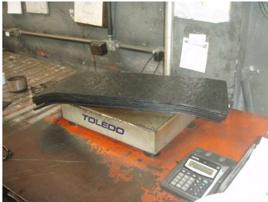
Figura 3.10 – Mistura final laminada e pesada para montagem do aparelho de apoio.
