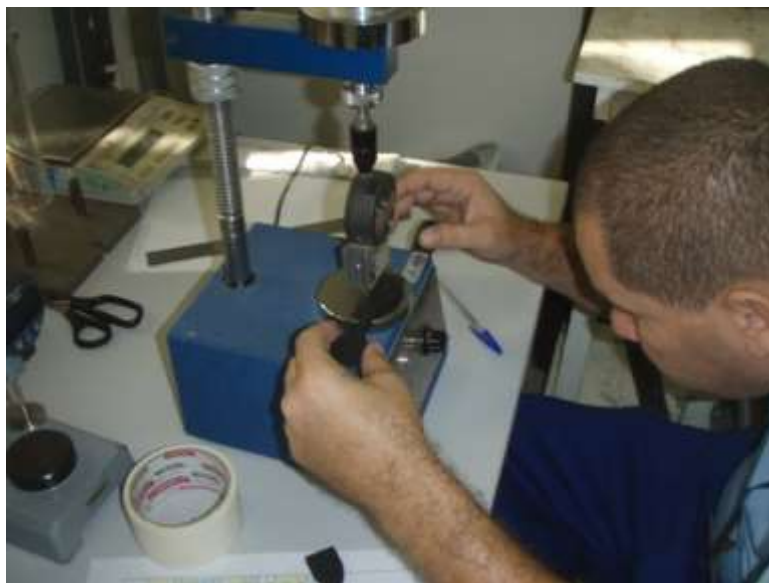
Figura 3.16 – Ensaio de dureza shore A.
