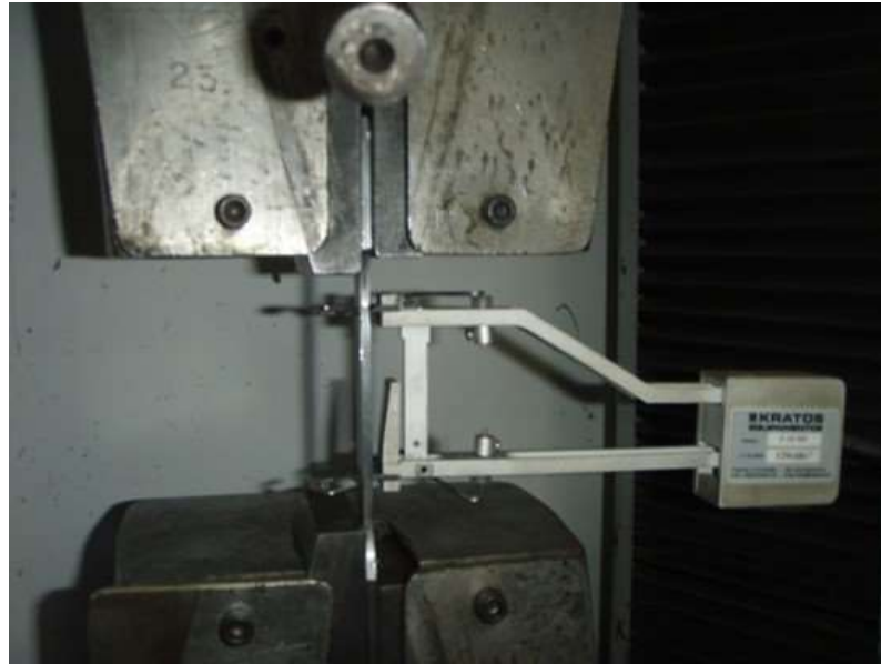
Figura 3.21 – Ensaio de ruptura a tração do aço das chapas fretantes.
