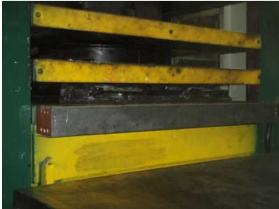
Figura 3.13 – Prensagem e vulcanização.
