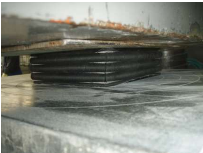
Figura 3.19 – Ensaio de compressão simples.
