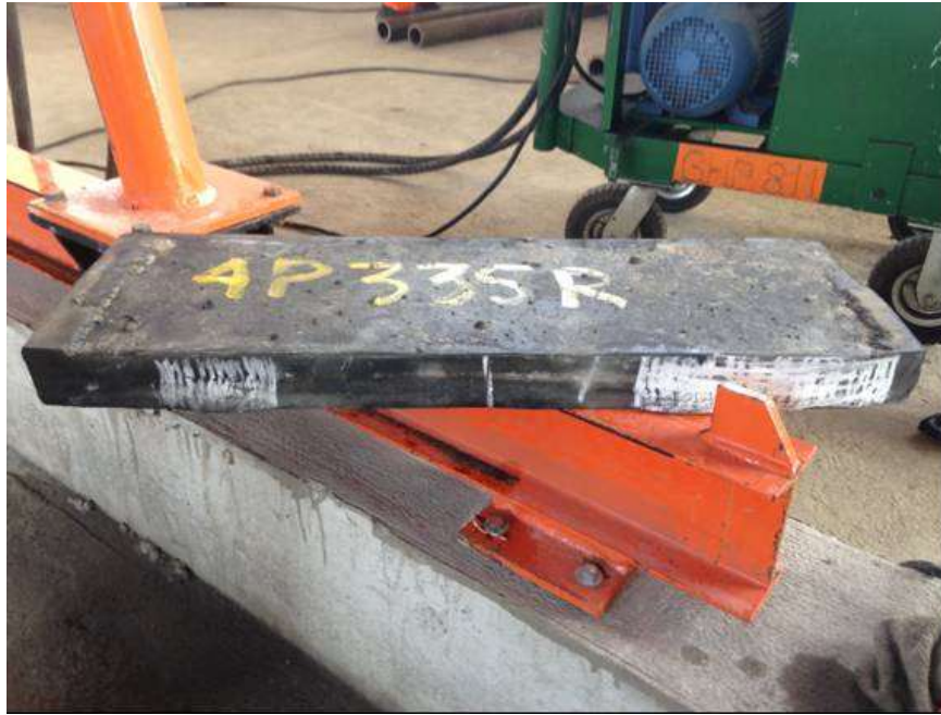
Figura 6.6 – Marcação com giz das anomalias principais nas faces laterais dos apoios.
