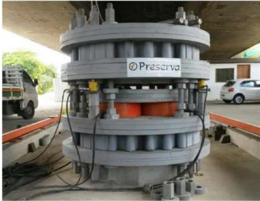
Figura 6.4 – Aparato de reação (prensa).
