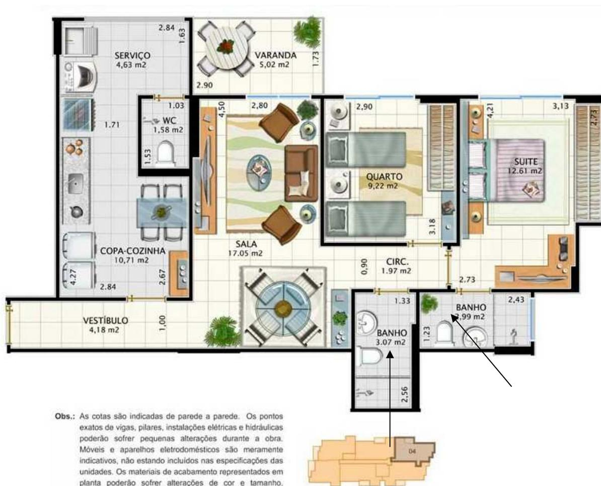
Figura 07- Planta –baixa sem escala apartamento / solução típica de banheiros ventilados por rebaixo .
