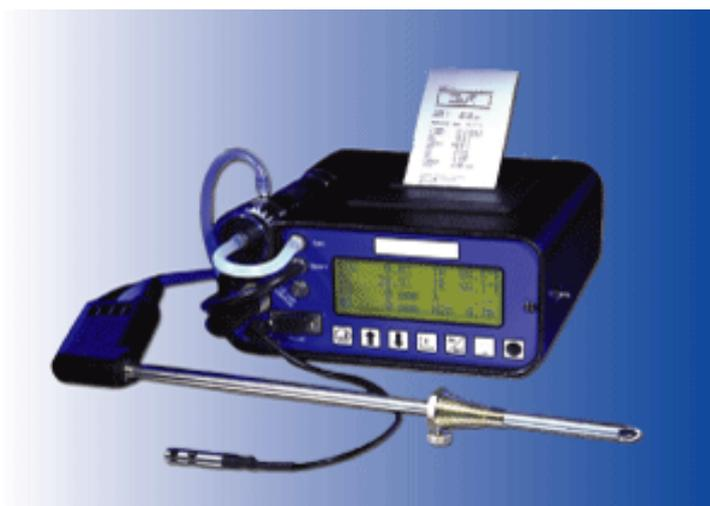
É um equipamento portátil e tem capacidade de medir 4 gases O<sub>2</sub>, CO, NO, NO<sub>2</sub> ou SO<sub>2</sub>. Mede gases oriundos da combustão e pode ser também usado no monitoramento ambiental. Possui células eletroquímicas para leitura dos gases e inclui um sensor automática de calibração.
