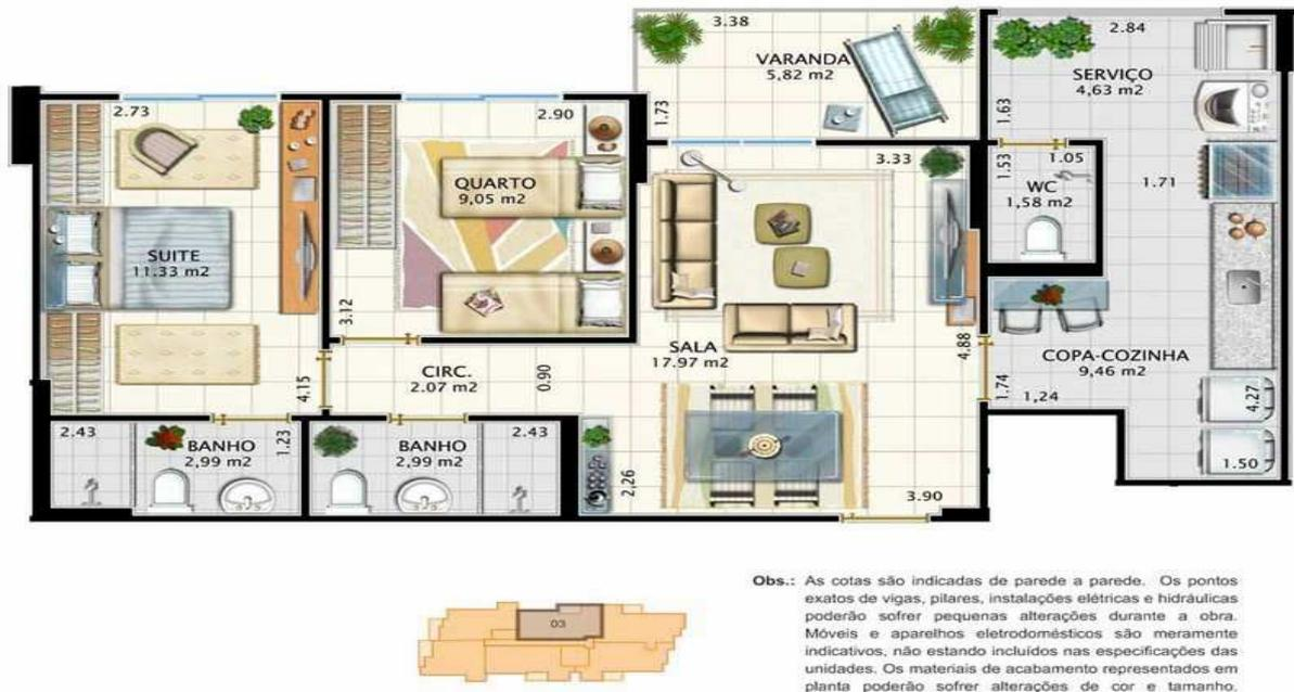
Figura 05 – Planta –baixa sem escala apartamento / solução típica de banheiros ventilados por exaustão mecânica.
