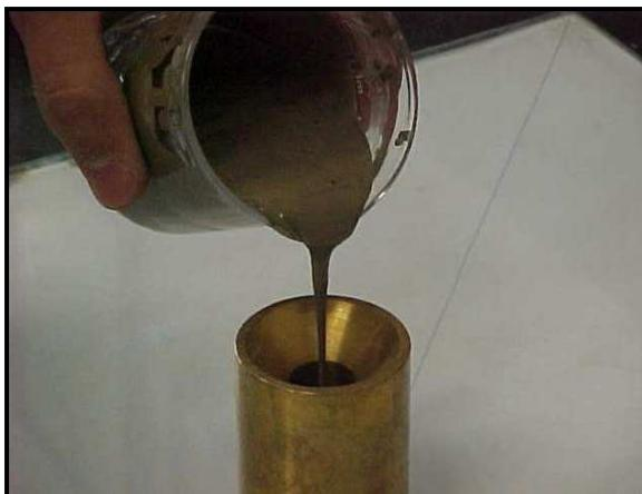
Figura 8.16 - Registro fotográfico do processo do ensaio de “Kantro”.
