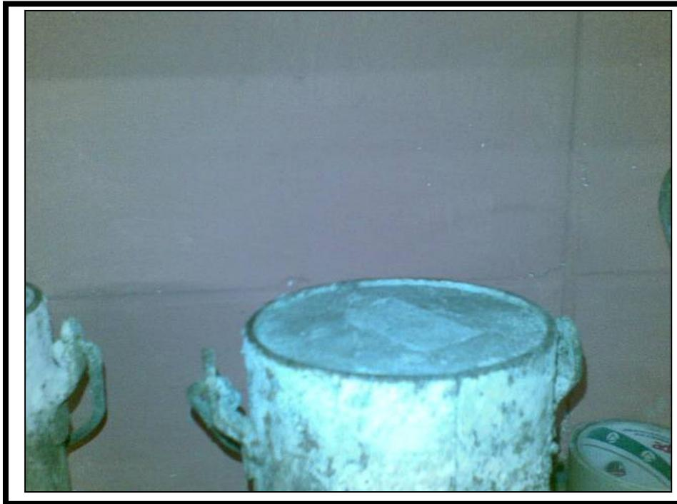
Figura 4.17: Posicionamento da forma, 2 a 3 mm acima do corpo de prova.
