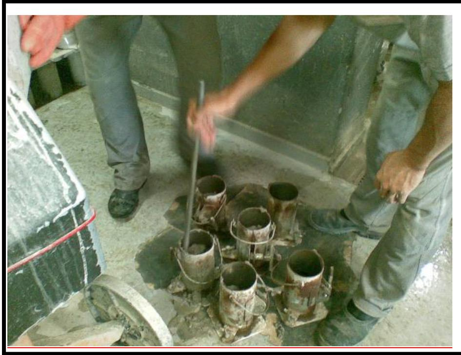
Figura 4.15: Moldagem em duas camadas com 13 golpes cada.
