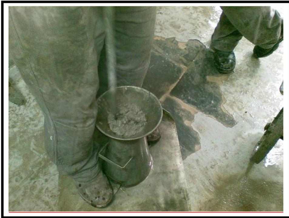
Figura 4.3: Golpeamento do concreto no tronco de cone em três camadas com 25 golpes cada.
