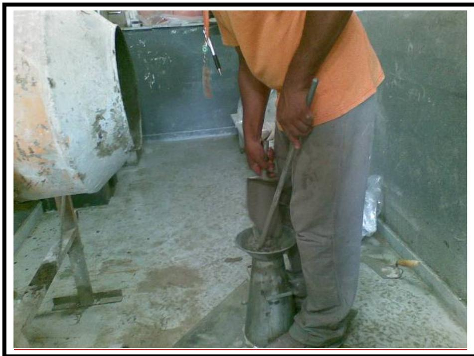
Figura 4.2: Colocação do concreto no tronco de cone em três camadas.
