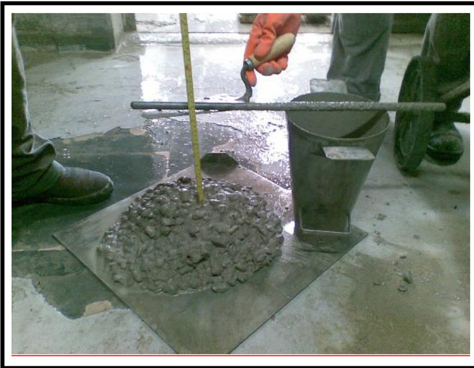
Figura 4.4: Medição do abatimento da amostra e avaliação visual da coesão.
