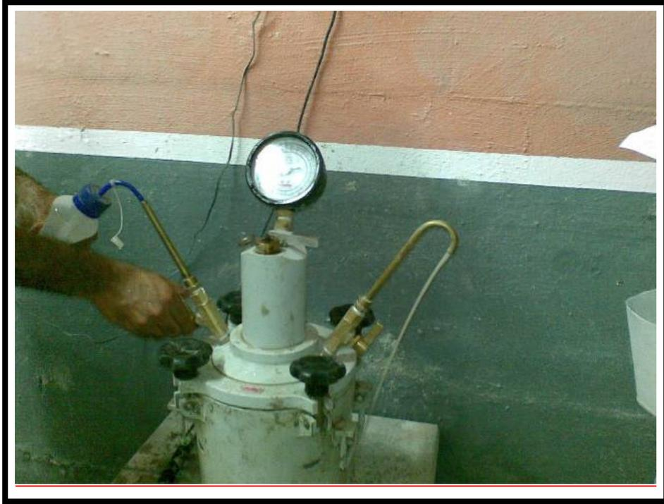
Figura 4.11: Colocação da água
