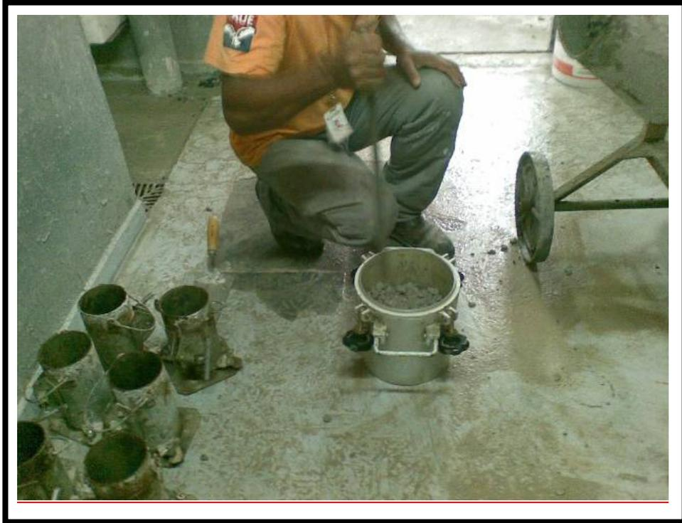
Figura 4.5: Colocação do concreto em 3 camadas com 14 golpes cada.
