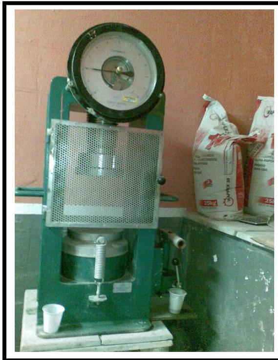
Figura 4.20: Prensa para rompimento Pavitest de 12,0 t
