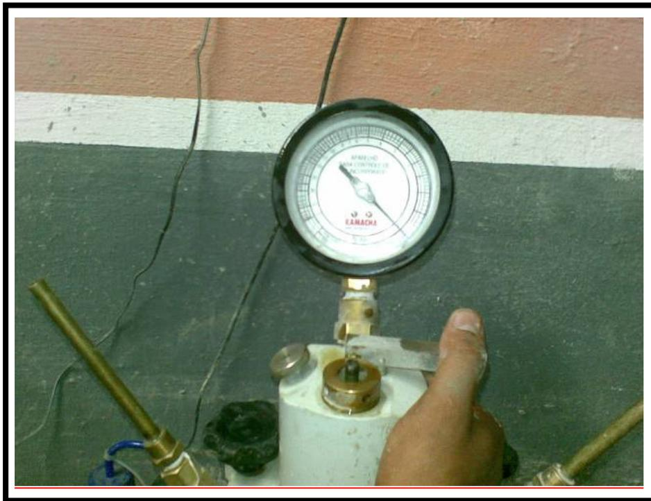
Figura 4.14: Tomada de pressão para determinação do teor de ar.
