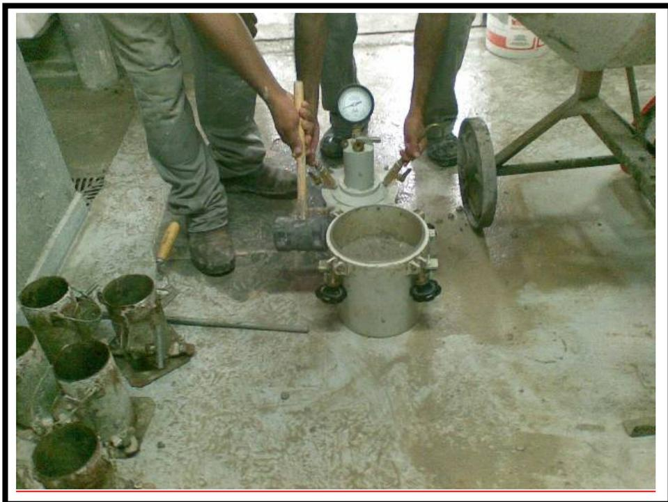
Figura 4.6: Golpes com martelo de borracha após adensamento de cada camada.
