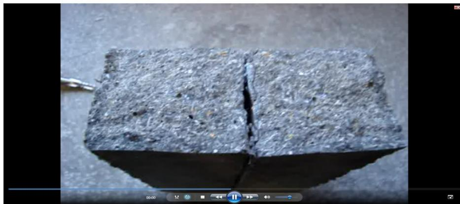
Figura 4.94 – Superfície de fratura de corpo de prova fraturado em flexão, da argamassa de cimento Portland reforçada por fibras de polipropileno, PP7.
