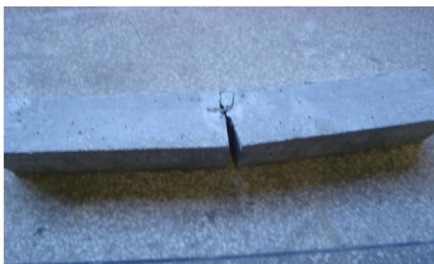
Figura 4.93 - Perfil do corpo de prova de integral J da argamassa de cimento Portland reforçada por fibra de aço inoxidável, AN7.
