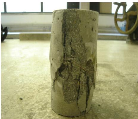
Figura 4.95 – Corpo de prova fraturado em compressão da argamassa de cimento aluminoso reforçada por fibras de aço inoxidável (AN7).
