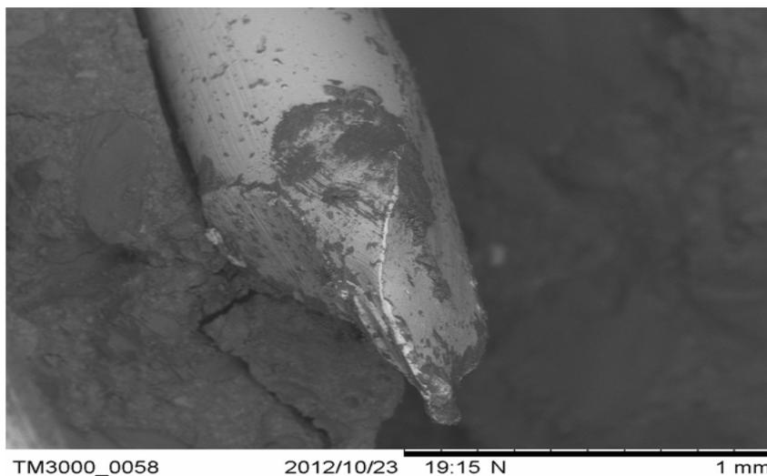
Figura 4.80 – Detalhe do acabamento da extremidade da fibra de aço inoxidável na superfície de fratura de corpo de prova ensaiado em impacto do compósito AN7.
