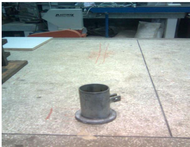
Figura 3.3 Molde utilizado na fabricação dos corpos de prova de compressão
