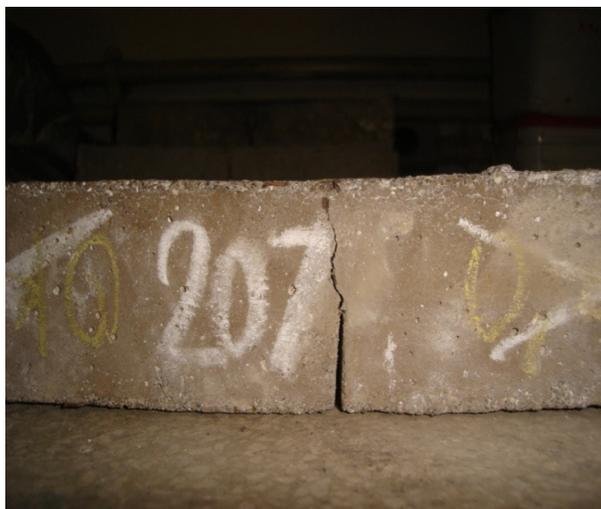
Figura 4.92 – Perfil do corpo de prova de integral J da argamassa plena de cimento aluminoso.
