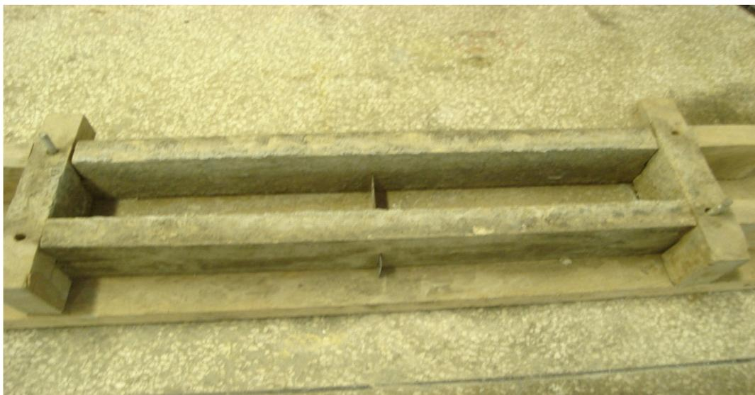
Figura 3.4 Esquema do molde utilizado na fabricação dos corpos de prova de flexão entalhados.
