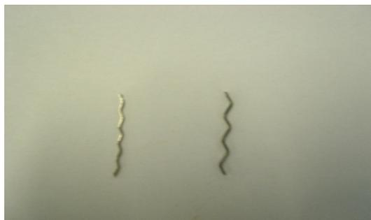
Figura 3.1 Esquema das fibras de aço inoxidável e ao carbono.
