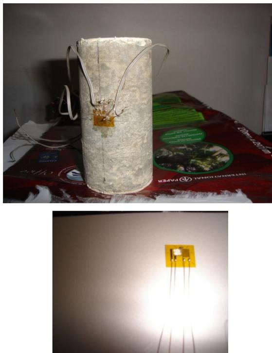
Figura 3.6 Extensômetro tipo L e corpo de prova preparado para ser ensaiado em compressão.
