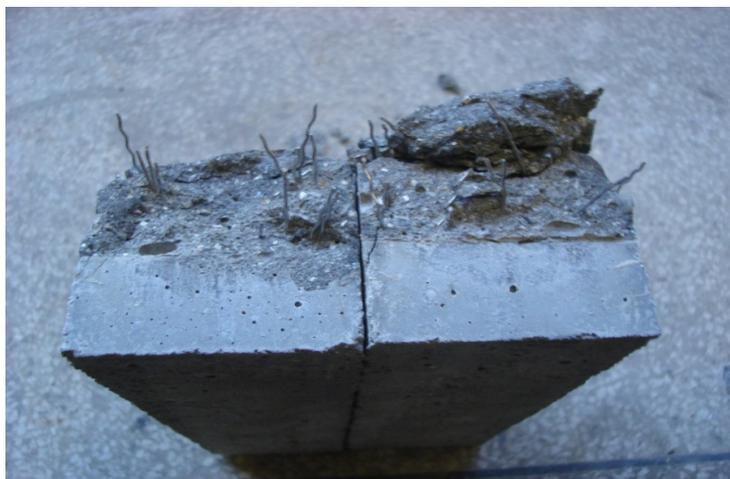
Figura 4.91 – Superfície de fratura de corpo de prova entalhado, de cimento Portland reforçado por fibras de aço inoxidável, AN7.
