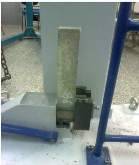
Figura 3.9 Orientação do corpo de prova na máquina de impacto.
