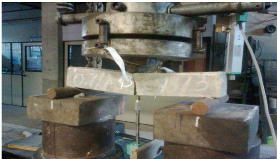
Figura 3.7 Esquema representativo de ensaio de flexão em compósito não entalhado utilizando LVDT para leitura da deflexão correspondente.
