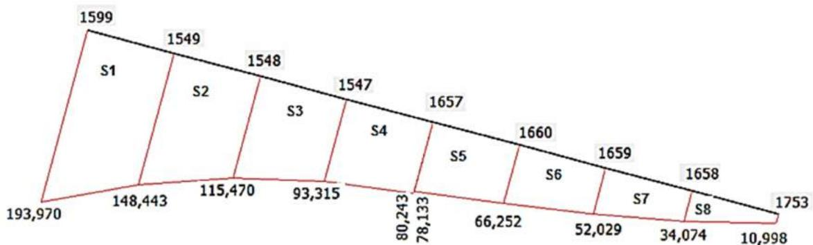
Figura 5.5 – Força axial no bulbo de 6,0 m na segunda fileira de tirantes.
