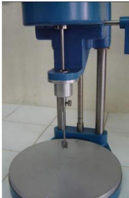
Figura 3.9 – Equipamento para o ensaio de palheta.
