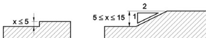
Figura 33: Tratamento de desníveis - Exemplo
