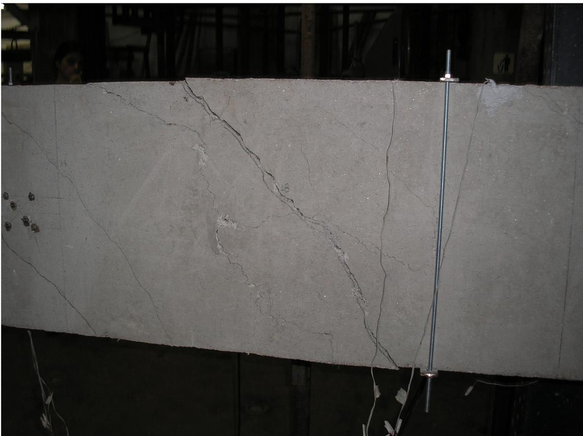
Foto 4.2 - Ensaio de Torção em viga de concreto armado, realizado por SILVA FIHO,2005.
